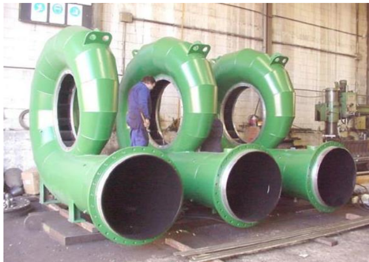
Figura 19. Cámara espiral turbina francis.
