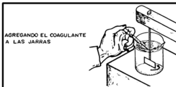
Fotografía N° 73: Agregando el coagulante a las jarras
