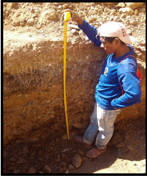
Ilustración 31 Calicata N°9– Línea de Conducción
