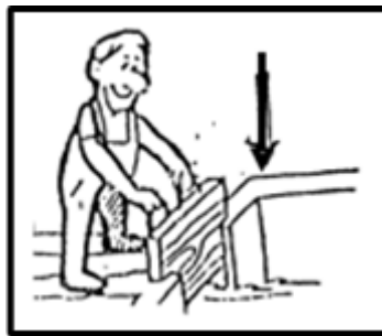
Fotografía N° 67: Cerrar la compuerta del canal
