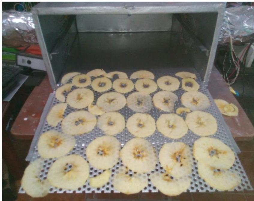
Figura N°76. Disposición de las muestras sobre la porta muestras.
