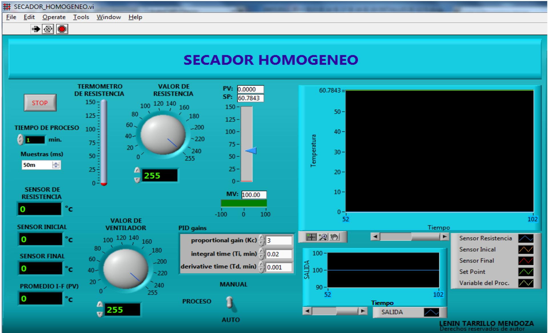
Figura N°90. Aspecto del software desarrollado para el secador de manzana
