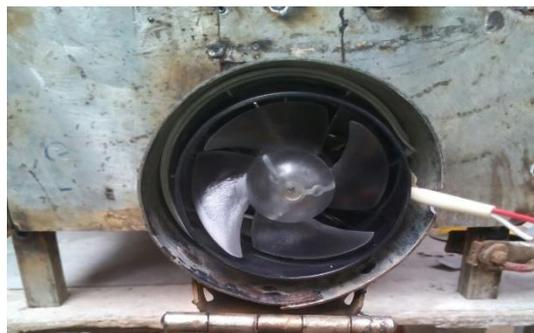
Figura N°73. Acople del ventilador al intercambiador de calor
