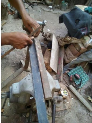
Figura N°65. Cortado de tubos cuadrangulares para la base de la cámara de secado.
