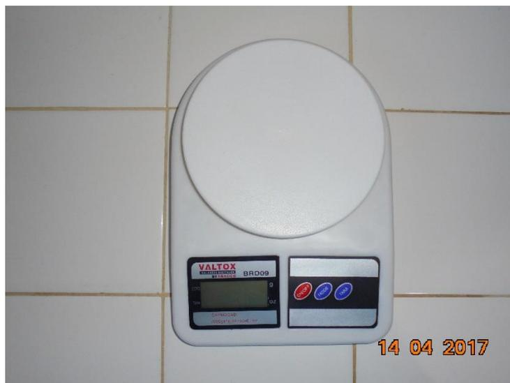
Figura N°19. Balanza digital, capacidad máxima 5kg, para realizar el pesado de las muestras de manzana.
