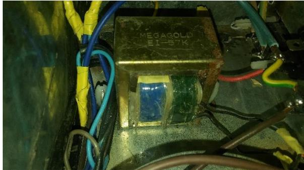
Figura N°56. Transformador de 220V-12V a usar.
