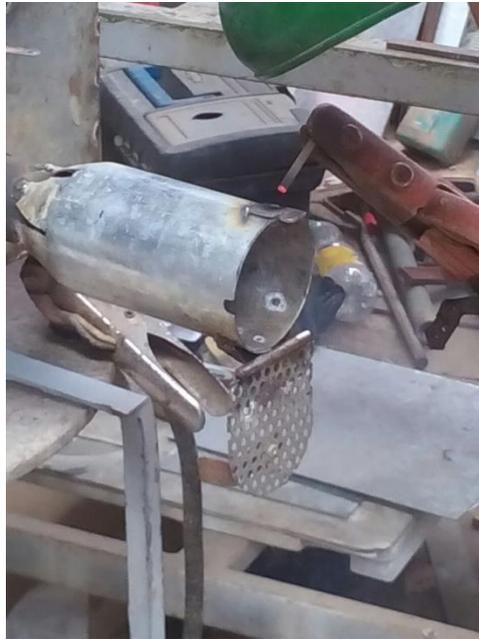
Figura N°62. Soldado del seguro y las bisagras de la puerta de mantenimiento del intercambiador
