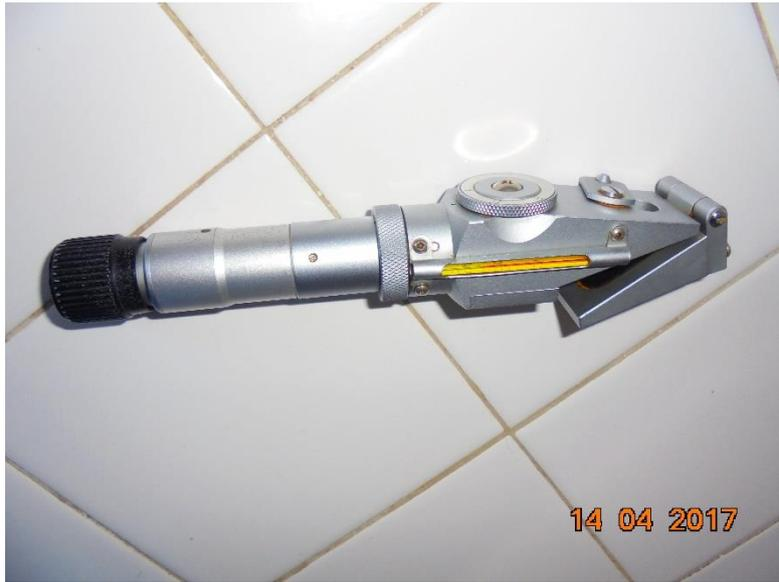
Figura N°21. Refractómetro, para medir los °BRIX de la manzana.
