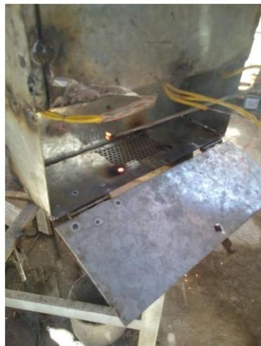
Figura N°66. Construcción y montaje del porta circuitos integrados.
