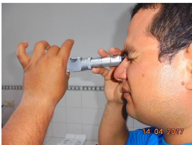
Figura N°30. Visualización de los grados °BRIX en el refractómetro.
