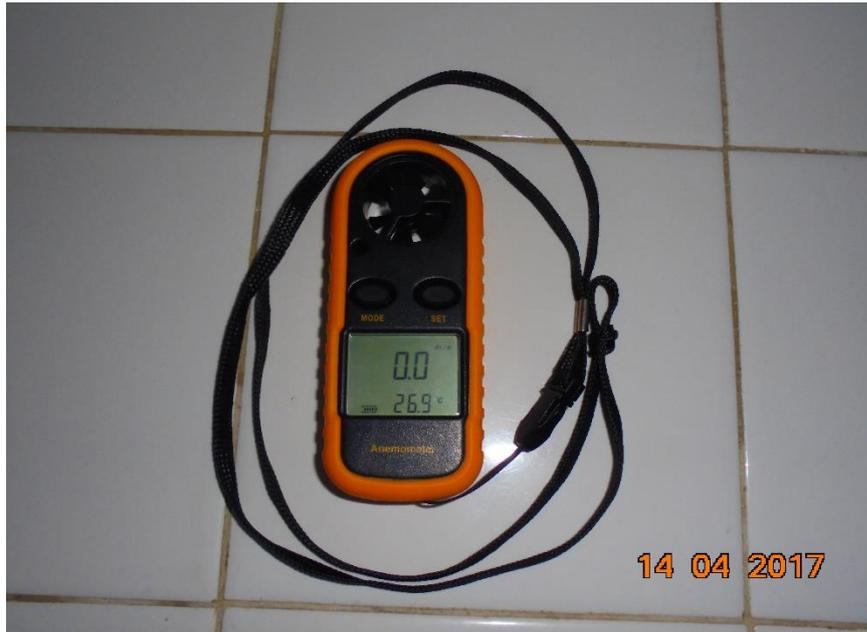
Figura N°23. Anemómetro con sensor de temperatura.
