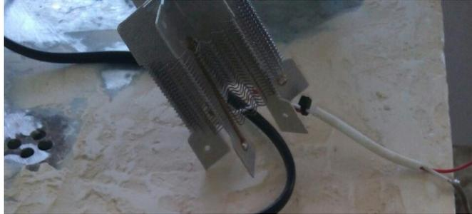
Figura N°72. Acople la resistencia al intercambiador de calor
