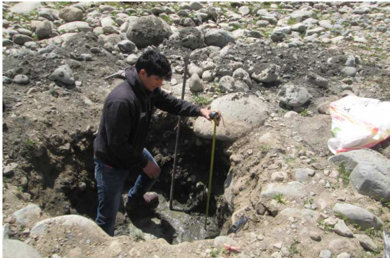
FOTO 3.3: Nivel freático de calicata C-01.
