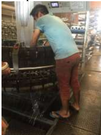
Figura 80: Operario cambiando hilo roto
