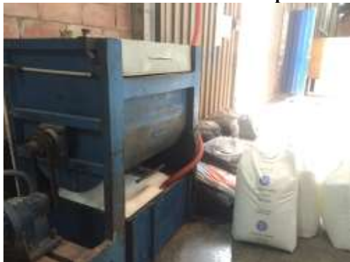
Figura 74: Tolva alimentadora de la etapa de extrusión
