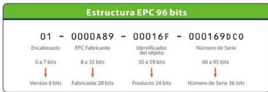
Figura N° 1. Estructura EPC 96 bits
