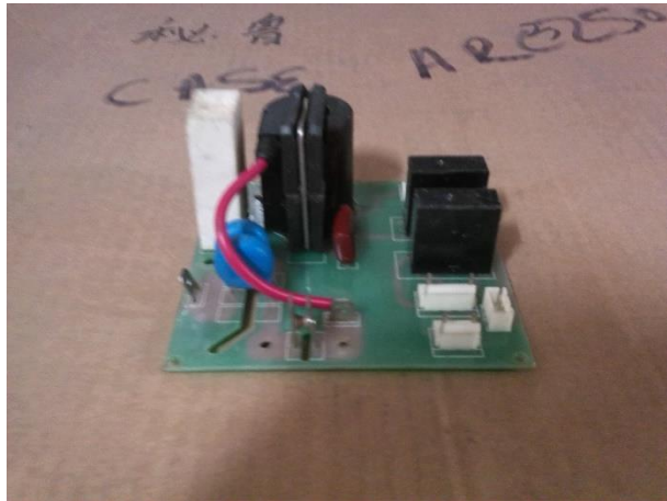
Figura 31. Tarjeta de alta frecuencia Fuente: SOLDAMUNDO IMPORTACIONES S.A.C.
