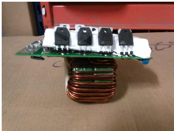
Figura 32. Tarjeta de diodos Fuente: SOLDAMUNDO IMPORTACIONES S.A.C.
