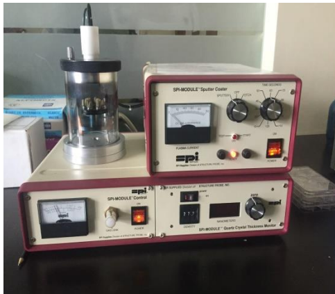
Fotografía 11 y 12. Baño con oro paladio (Metalizado) de los grupos experimentales después de la retropreparación apical para ser observados al microscopio electrónico de barrido (SEM).
