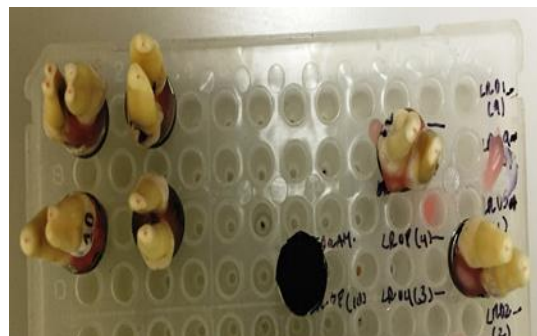
(Fotografía 02 y 03. Acondicionamiento de los grupos experimentales con resectación apical sin metalizado; para poder ser observados al Microscopio electrónico de barrido y registrar posibles micro fisuras antes de la retropreparación apical.
