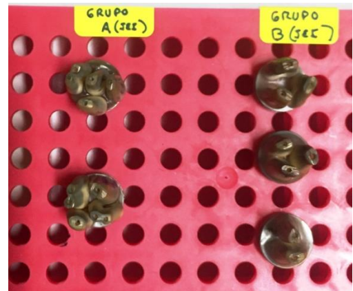
Fotografía 11 y 12. Baño con oro paladio (Metalizado) de los grupos experimentales después de la retropreparación apical para ser observados al microscopio electrónico de barrido (SEM).
