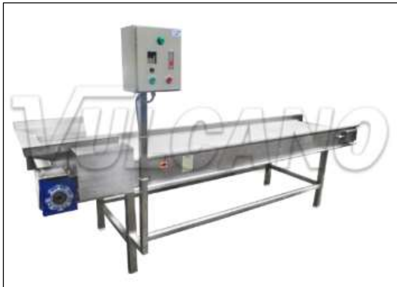
Figura 38. Faja transportadora Fuente: Vulcano, 2019
