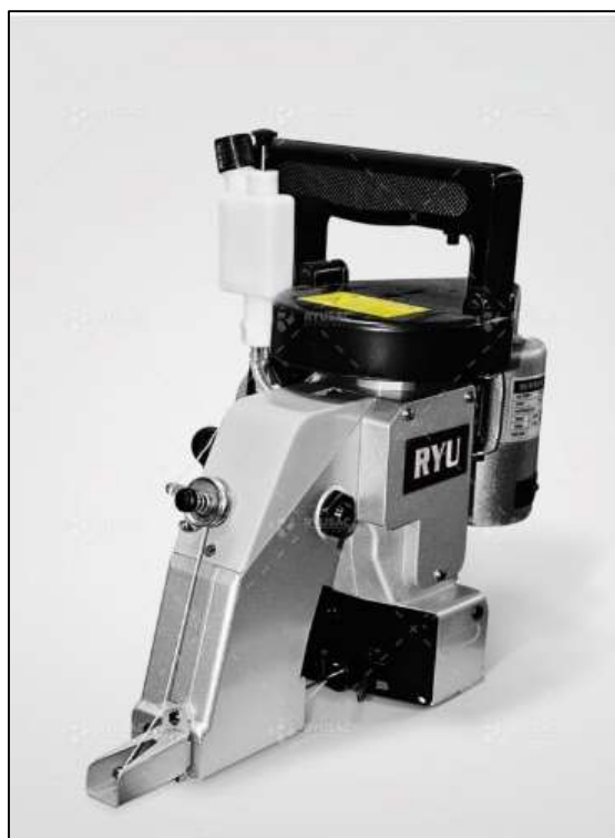
Figura 40. Cosedora de sacos Fuente: Ryu S. A. C., 2017
