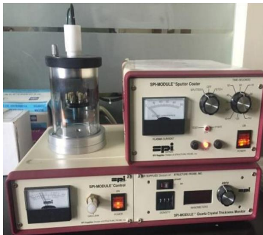
Fotografía 14. Baño con oro paladio (Metalizado) de grupos experimentales después de la retropreparación apical para ser observados en el microscopio electrónico de barrido (SEM).
