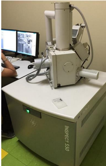
Fotografía 04. Microscopio electrónico de barrido modelo INSPECT S50 fabricación 2015; de la Facultad de Microbiología de la Universidad Nacional Mayor de San Marcos Lima - Perú.
