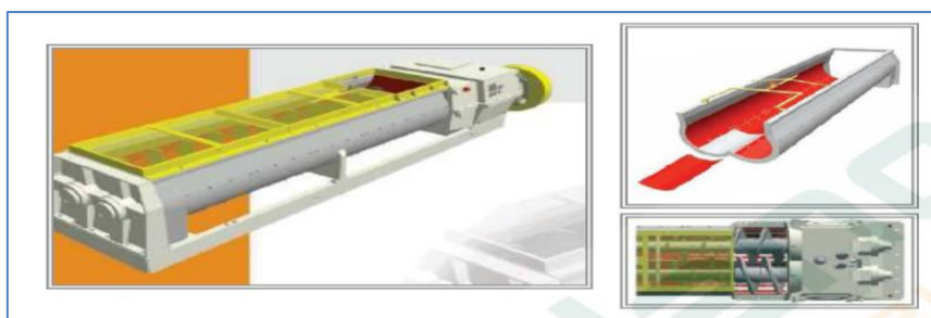
FIGURA N° 15: Máquina desintegradora de materia prima
