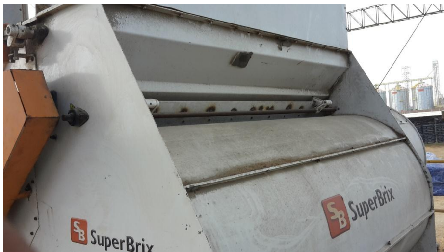
Ilustración 9: Máquina pre-limpiadora de granos.
