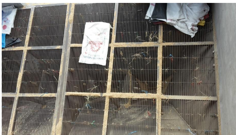
Ilustración 4: Tolva de recepción del grano de arroz (vista superior).
