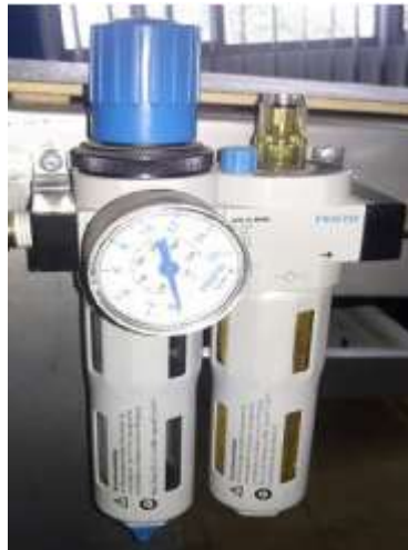
Figura 26. Unidad de filtro
