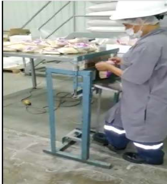
Figura 18. Sellado de bolsa por operador.
