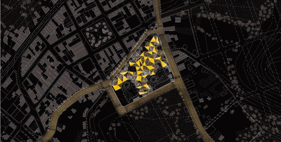
Por otro lado, la cubierta se integra a la arquitectura propuesta debido a las condiciones climáticas del lugar, la disposición de la cubierta genera el aprovechamiento agua pluvial como recurso hídrico, además el tratamiento de la cubierta formando llenos y vacíos permite el ingreso de la luz natural durante el día, y de esta manera se logra una edificación sostenible.
