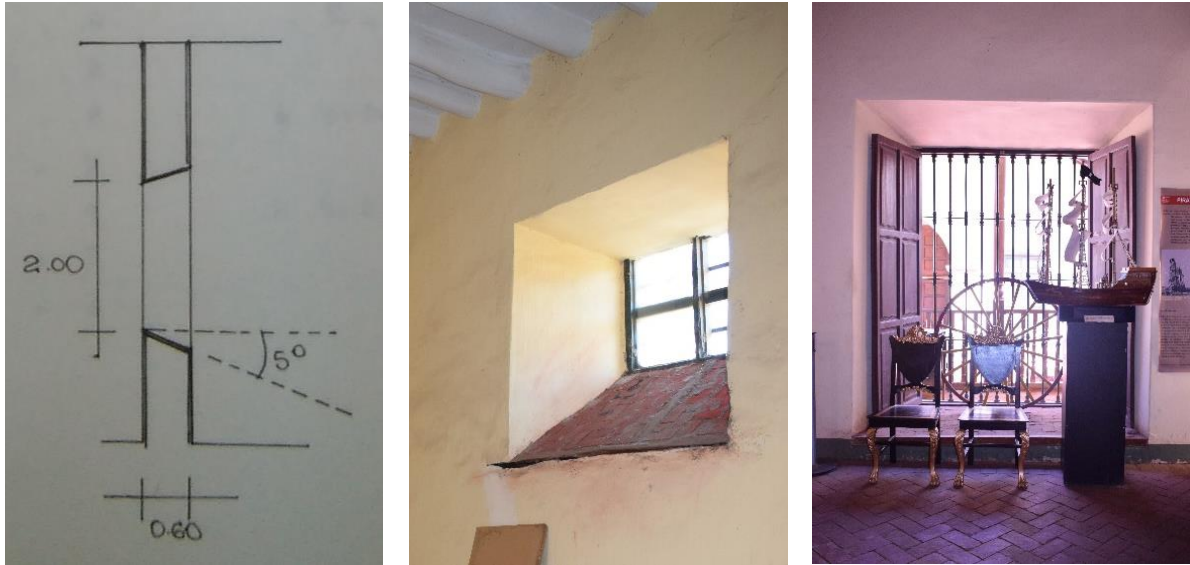
Imagen 62. Diseño y Fotografía de un vano exterior e interior de la Casona Montjoy. Fuente Propia
