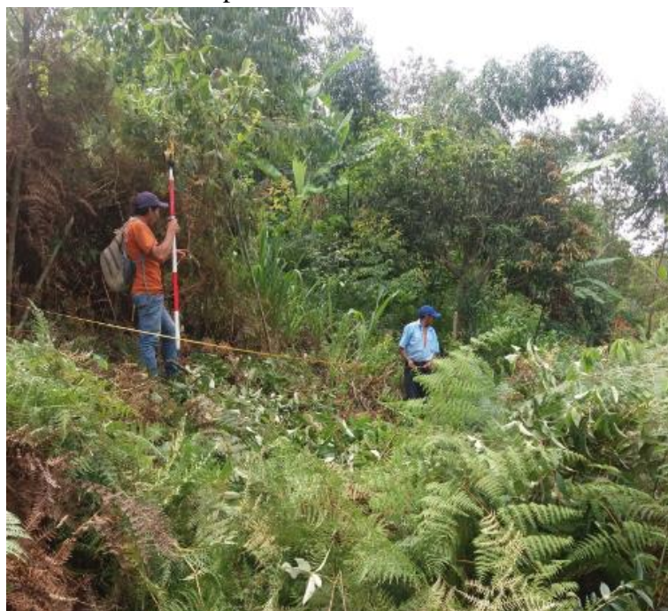
Fotografía N°. 7: Personal de apoyo en el despeje y medición para seccionar cada 20 metros.
