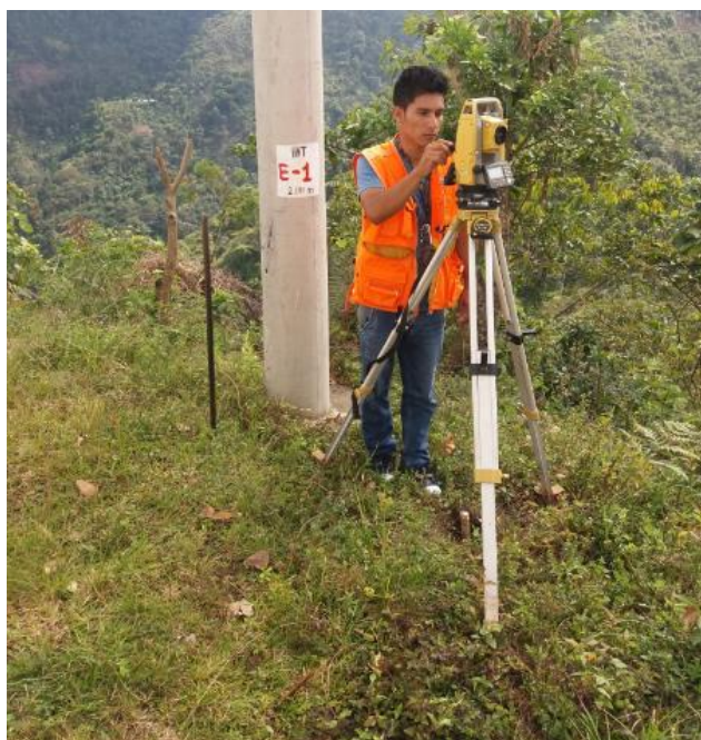
Fotografía N°. 5: Estación total usada en el levantamiento topográfico
