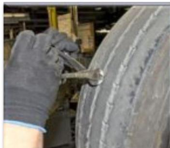
**Carcasa en la máquina de inspección para encontrar separaciones en neumáticos radiales**
