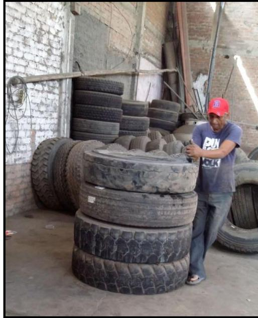
**Figura N° 11: Etapa de limpieza y retiro de la banda en mal estado**
