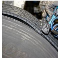
**Carcasa lista para el autoclave de vulcanización**
