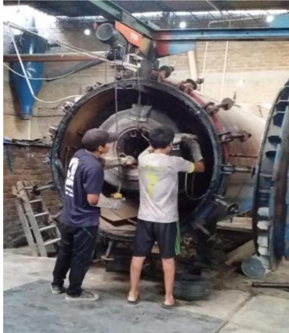
**Figura N° 32: Operarios no cuentan con EPP's adecuados para realizar sus funciones**
