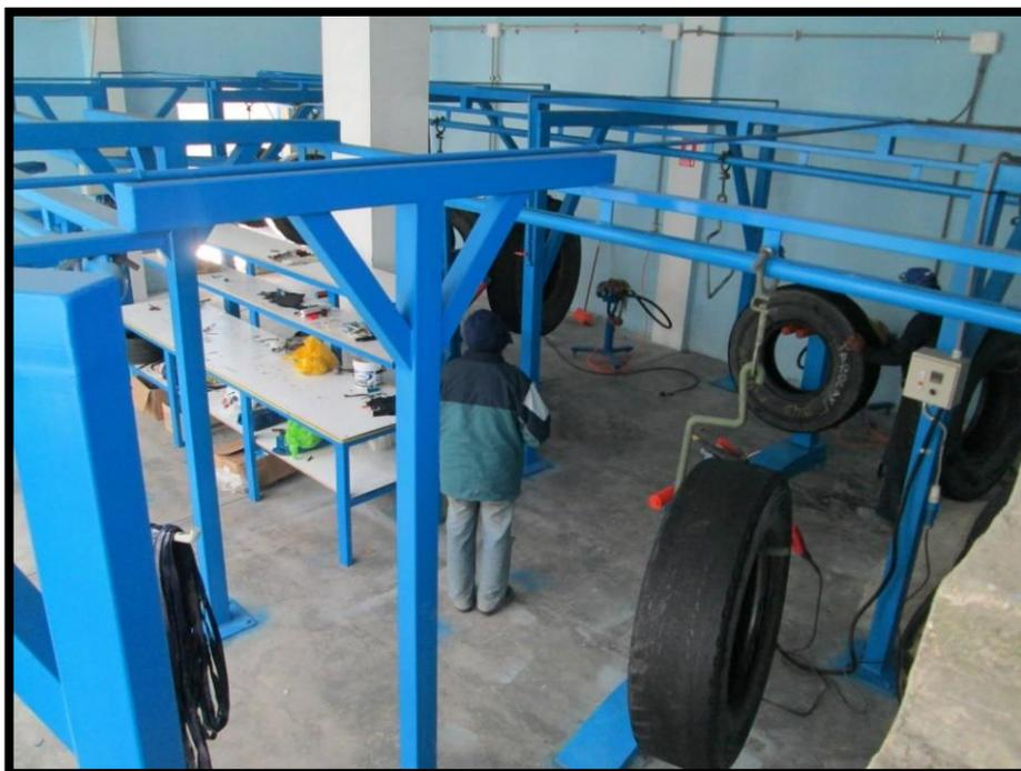
**Figura N° 33: Monovías para el área de reencauche de neumáticos**
