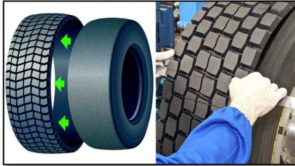
**Figura N° 2. Reencauche de neumáticos**
