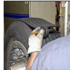
**Igualación del patrón de la banda de rodamiento en la unión**
