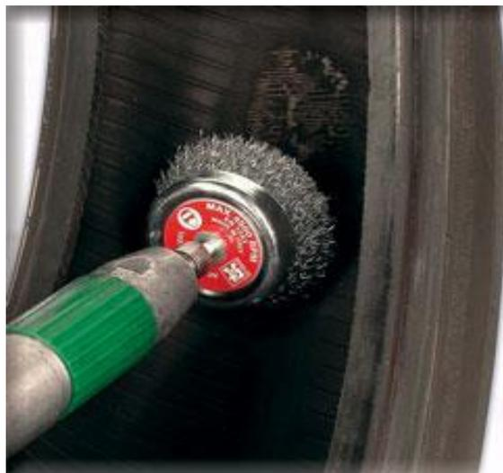
**Figura N° 38: Cepillos circulares para limpieza del neumático**
