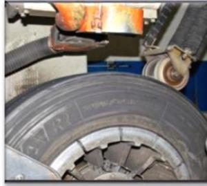
**Eliminación del daño - Área de la banda de rodamiento**
