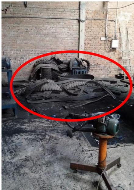
**Figura N° 26: Desperdicios ubicados en la etapa de preparación de banda**
