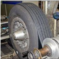
**Corte de los extremos de la banda de rodamiento a la longitud correcta**
