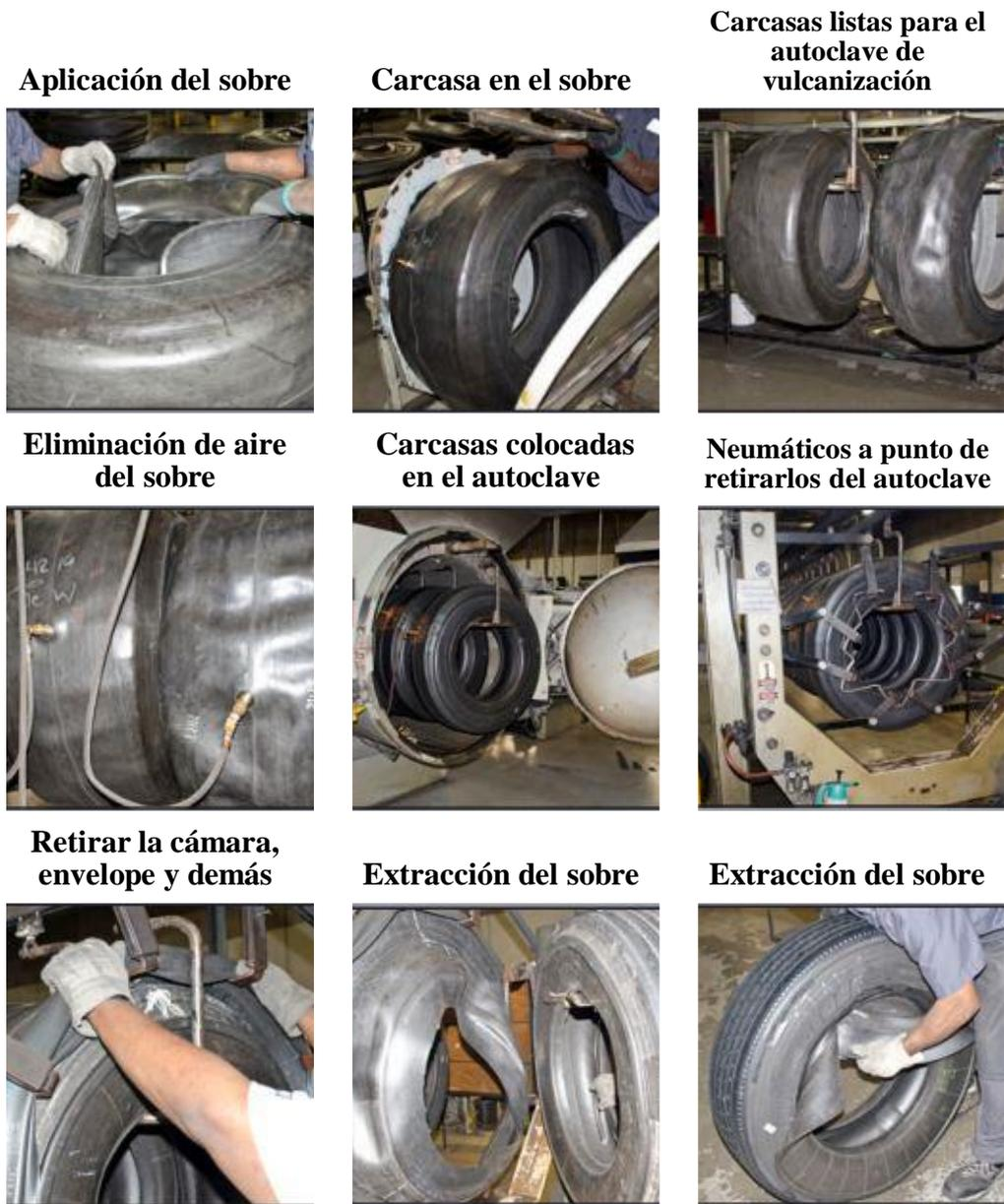
**Figura N° 45: Procedimiento para la etapa de vulcanizado**
