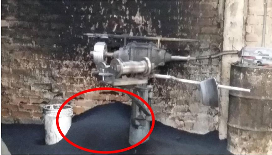
**Figura N° 28: Material particulado generado en la etapa de escareado**
