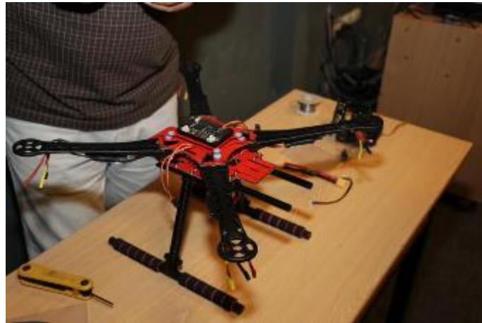
Fig. 21. Calibración de tarjeta Ardupilot en la aeronave Fuente: Elaboración propia.
