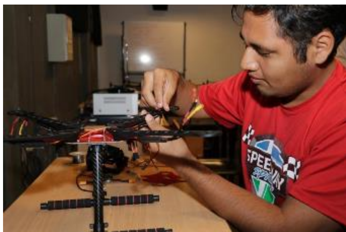
Fig. 20. Conexión de cables en la aeronave Fuente: Elaboración propia.
