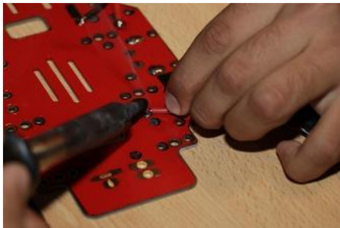
Fig. 17. Soldando cable en placa usado en la aeronave Fuente: Elaboración propia.
