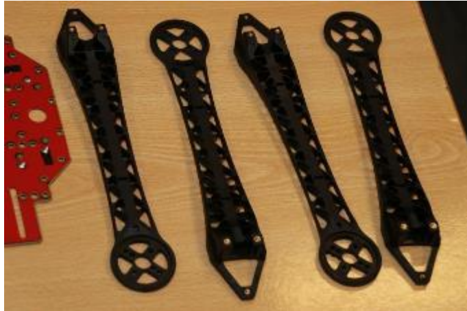
Fig. 14. Hélices o brazos usados en la aeronave Fuente: Elaboración propia.
