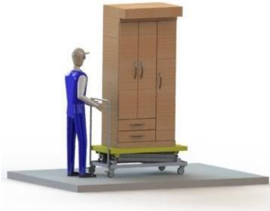
Figura 158. Operario transportando ropero con el apoyo mecánico Fuente: LEONCITO SOCIEDAD ANÓNIMA
