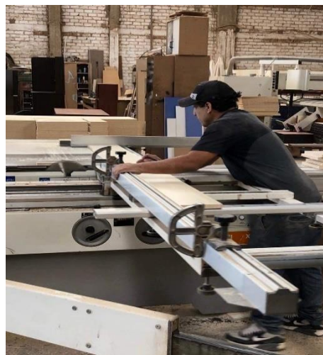
Figura 33. Operario sin mascarilla
