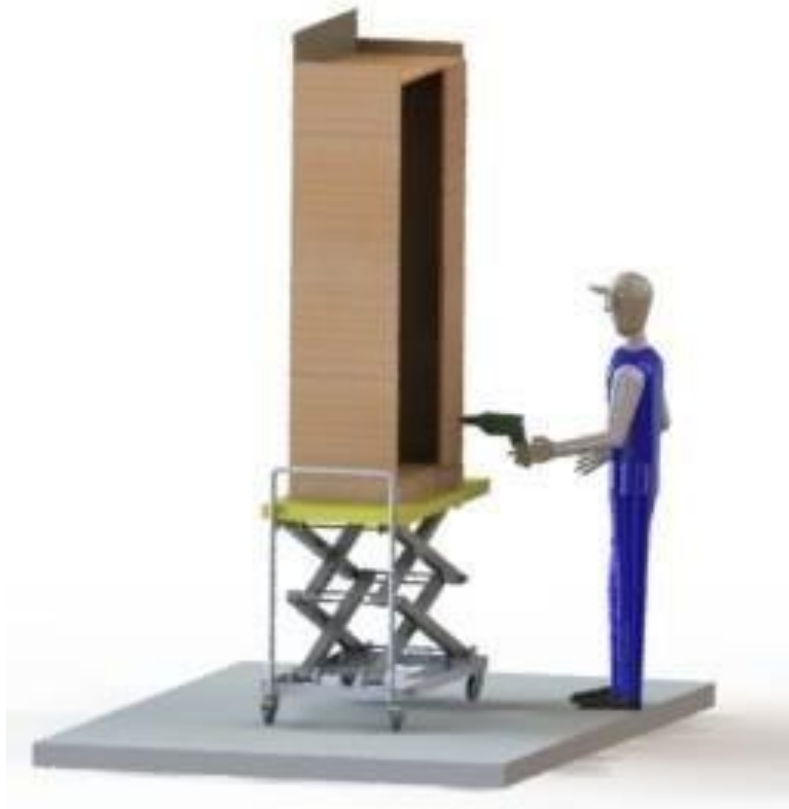
Figura 146. Operario ensamblando con el apoyo mecánico
