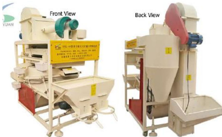
Figura 35. Prelimpiadora HYL-80. Vista frontal y trasera. Fuente: HONGYUAN 2020
