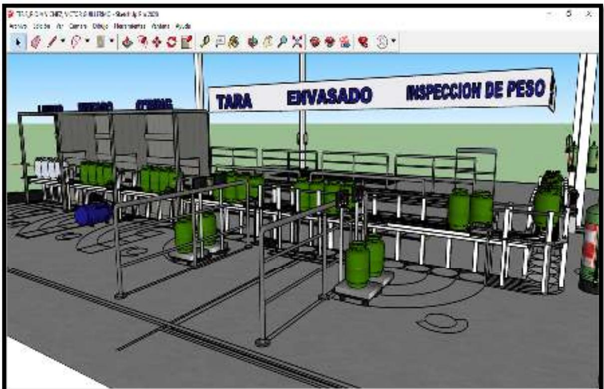
**Figura 145. Vista Isométrica derecha en 3D del rediseño de las estaciones de trabajo y edificaciones en la Plataforma del proceso de envasado de GLP en balones**
