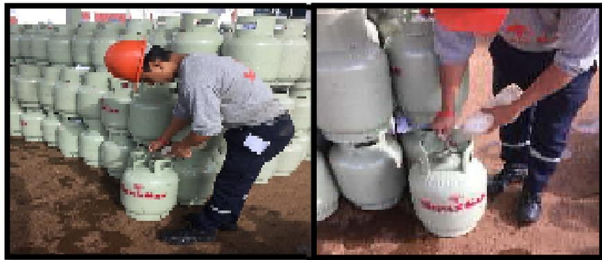
**Figura 58. Inspección del estado del O' Ring, extracción e instalación de un nuevo O' Ring en la válvula del balón**
