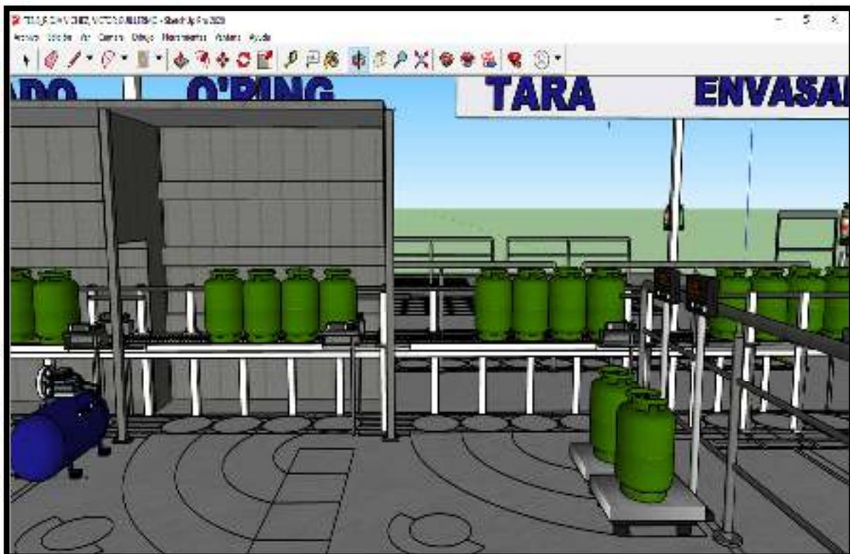
**Figura 147. Rediseño en 3D del tercer y cuarto puesto de trabajo encargados de las tareas de O´ Ring y tara del proceso de envasado de GLP en balones respectivamente**
