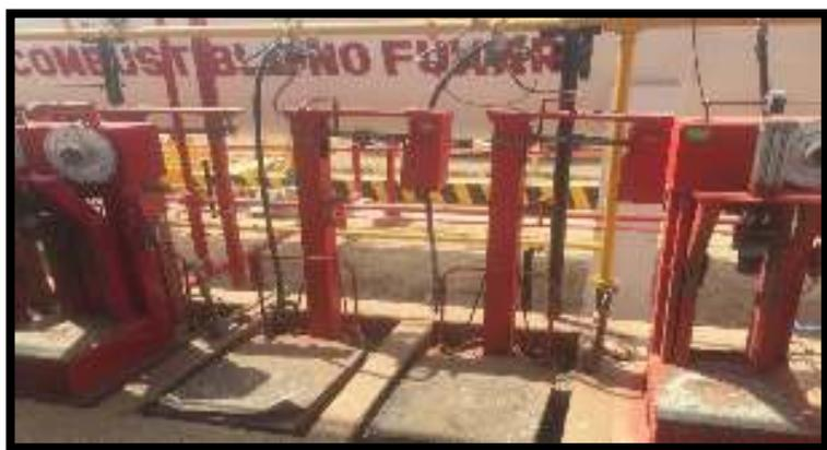
**Figura 21. Dos balanzas de tipo mecánico para envasar cilindros de 45 kg de GLP en el centro de la Estación de trabajo N°3 de la empresa**
