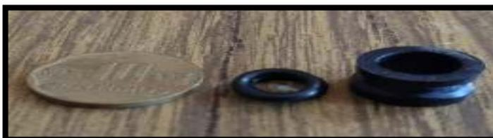
**Figura 15. O´ Ring de la válvula del balón con GLP**
