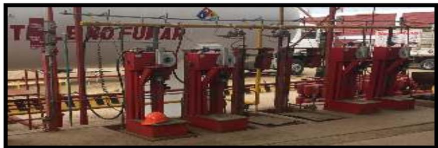
**Figura 19. Seis balanzas de tipo mecánico para envasar cilindros de 3 kg, 5 kg, 10 kg, 15 kg y 45 kg de GLP en el lado izquierdo de la Estación de trabajo N°3 de la empresa**
