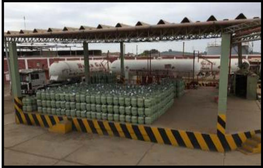
**Figura 60. Almacenamiento temporal del producto terminado hasta su despacho en los camiones distribuidores**
