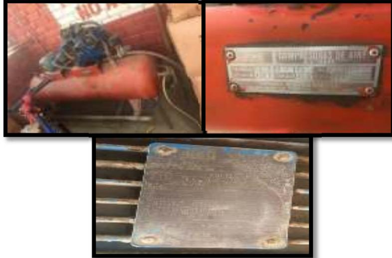
**Figura 18. Compresora marca “Romer” de 5 HP que abastece el sistema neumático de la empresa**
