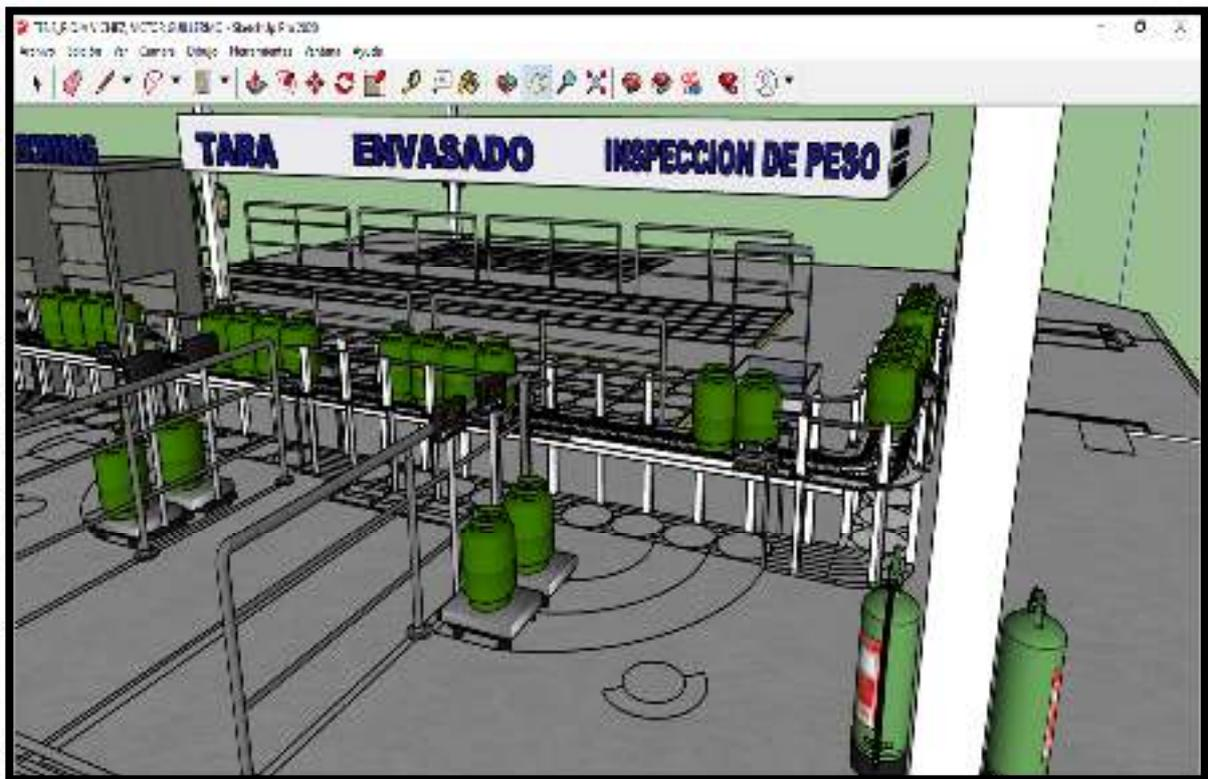
**Figura 148. Rediseño en 3D de la estación automatizada encargada de la operación de envasado de GLP y del quinto puesto de trabajo encargado de la tarea de inspección de peso del proceso de envasado de GLP en balones**
