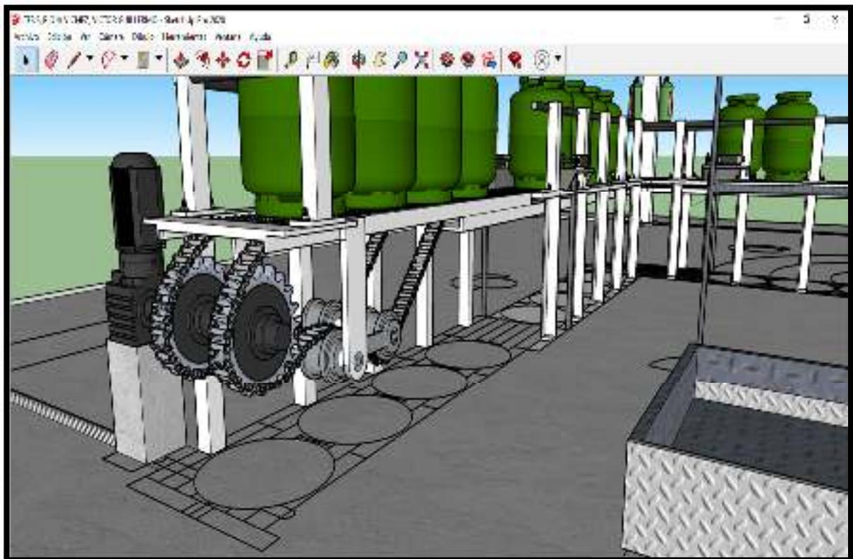
**Figura 152. Diseño isométrico en 3D del sistema de transmisión de la máquina transportadora por cadena de arrastre del sistema automatizado**
