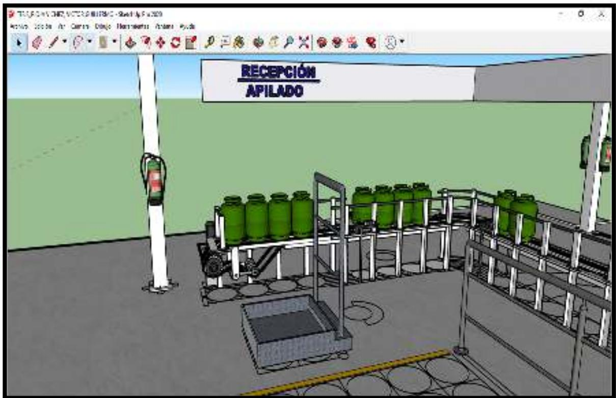
**Figura 150. Rediseño en 3D del sétimo puesto de trabajo encargado de las tareas de recepción y apilado del producto terminado en el almacén temporal de la Plataforma de Producción**
