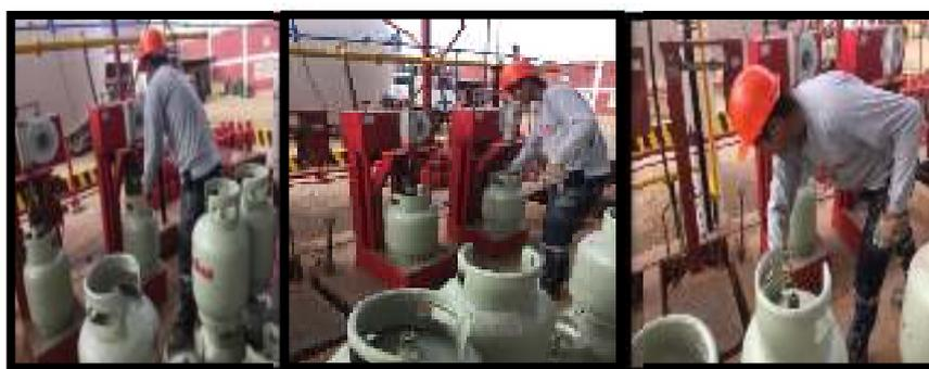
**Figura 55. Envasado del GLP en el balón vacío**
