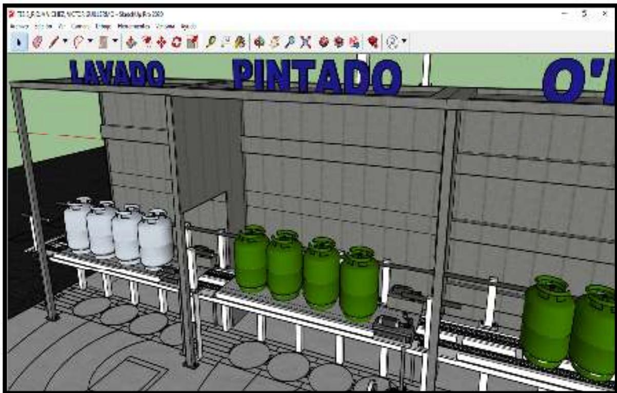
**Figura 146. Rediseño en 3D del primer y segundo puesto de trabajo encargados de las tareas de lavado y pintado del proceso de envasado GLP en balones respectivamente**
