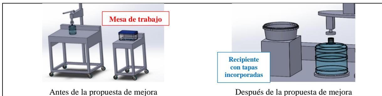
**Figura 7. Incorporación de recipiente en máquina de tapado**
