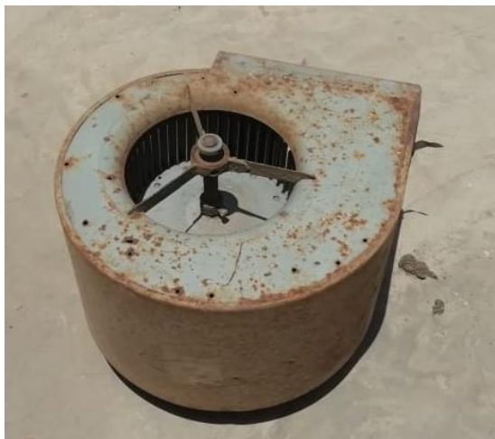
Ilustración 55 Soplador en estado inicial
