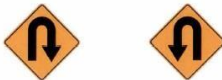
FIGURA N° 24: Señal curva en “U” a la derecha e izquierda (P-5-2A) (P-5-2B)
