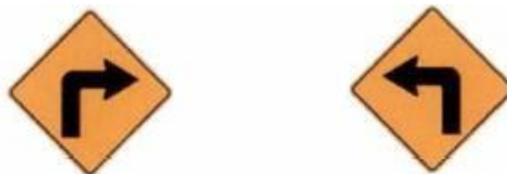
FIGURA N° 19: Señal de curva pronunciada a la derecha e izquierda (P-1A) (P-1B)
