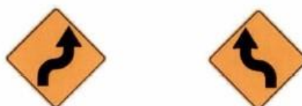
FIGURA N° 22: Señal de curva y contra curva a la derecha e izquierda (P-4A) (P-4B)
