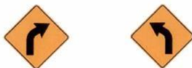
FIGURA N° 20: Señal de curva a la derecha e izquierda (P-2A) (P-2B)
