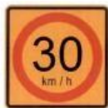
FIGURA N° 29: Señal velocidad máxima permitida en curva (R-30F)
