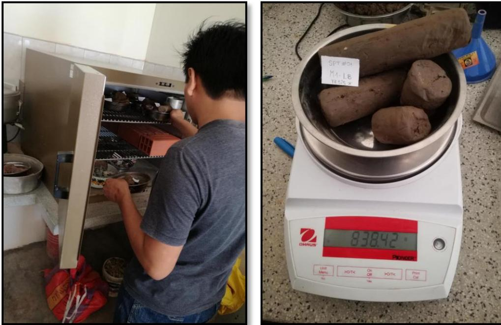
Figura 23 Pesar todas las muestras obtenidas en campo y colocarlas al horno
