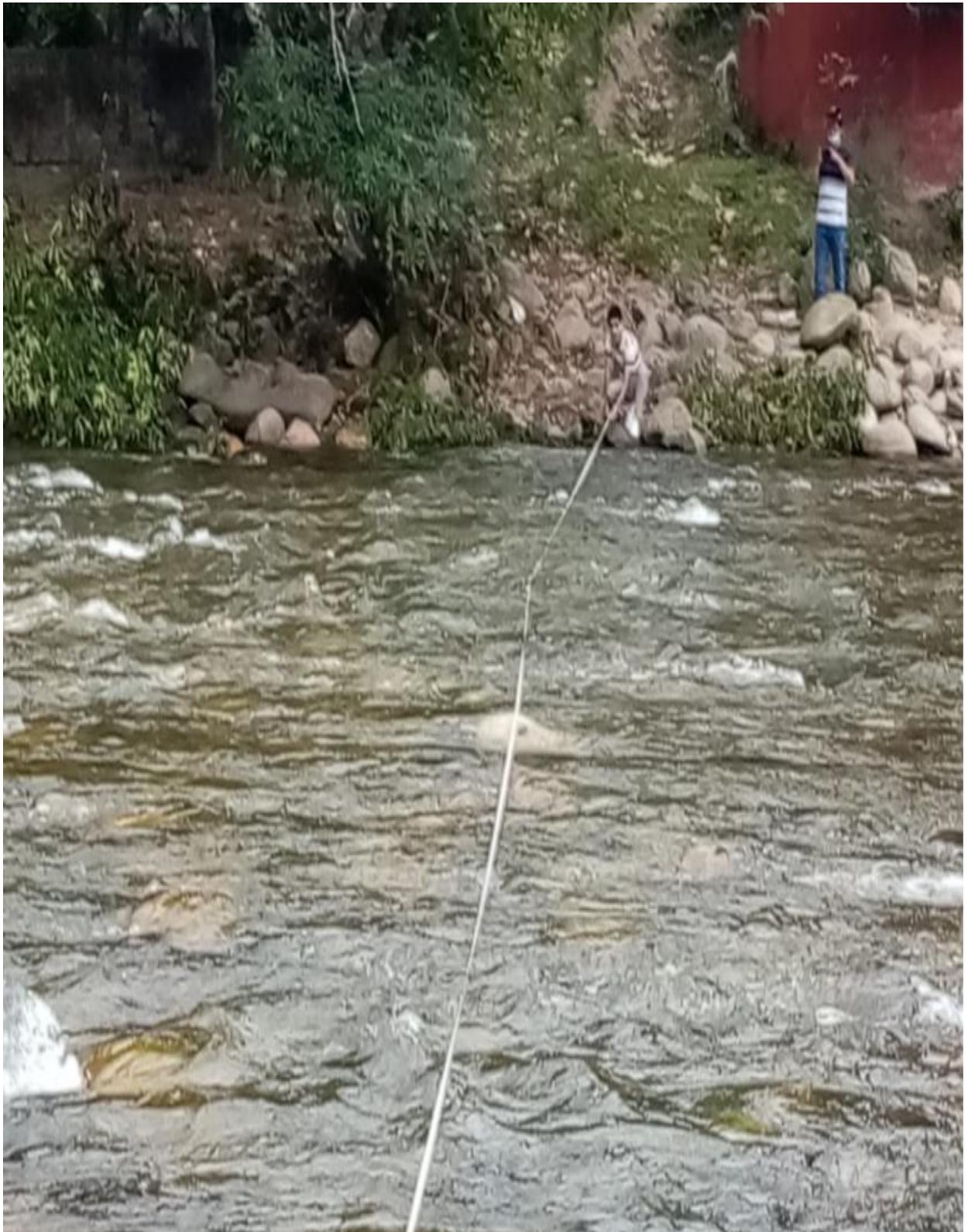
*Figura 58: Medición de ancho del río
