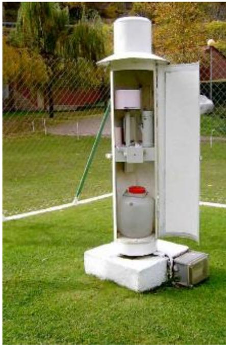
*Figura 3: Pluviógrafo y sus componentes*
