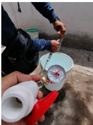
Fotografía 32: Realizando las lecturas manométricas de la presión de agua en Vista Florida
