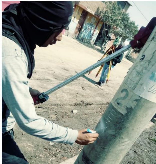
Fotografía 16: Levantamiento topográfico, marcando puntos de referencia
