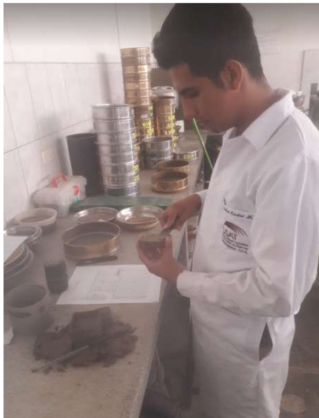
FOTOGRAFÍA N°6: Preparando muestra para ensayo de corte directo.
