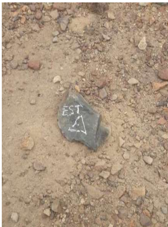
FOTOGRAFÍA N°1: Punto de estación
