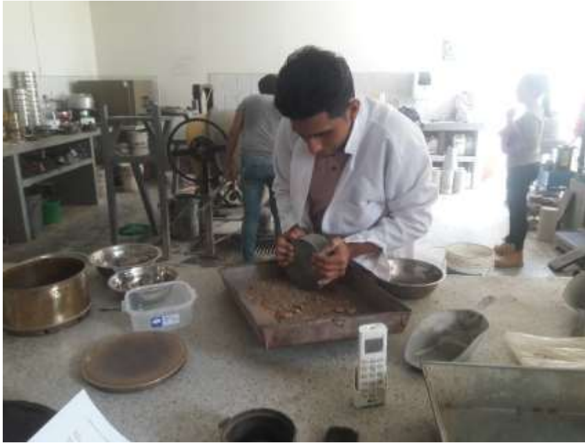
FOTOGRAFÍA N°5: Triturando muestra de suelo.
