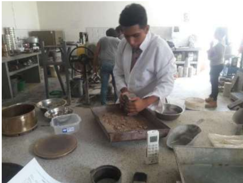
Fotografía N°11: Chancando muestras para Proctor
