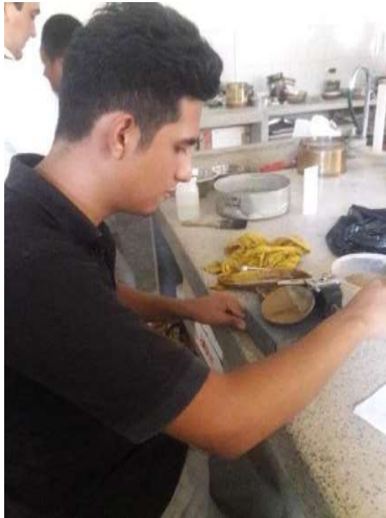
Fotografía N°9: Utilizando la Copa Casagrande
