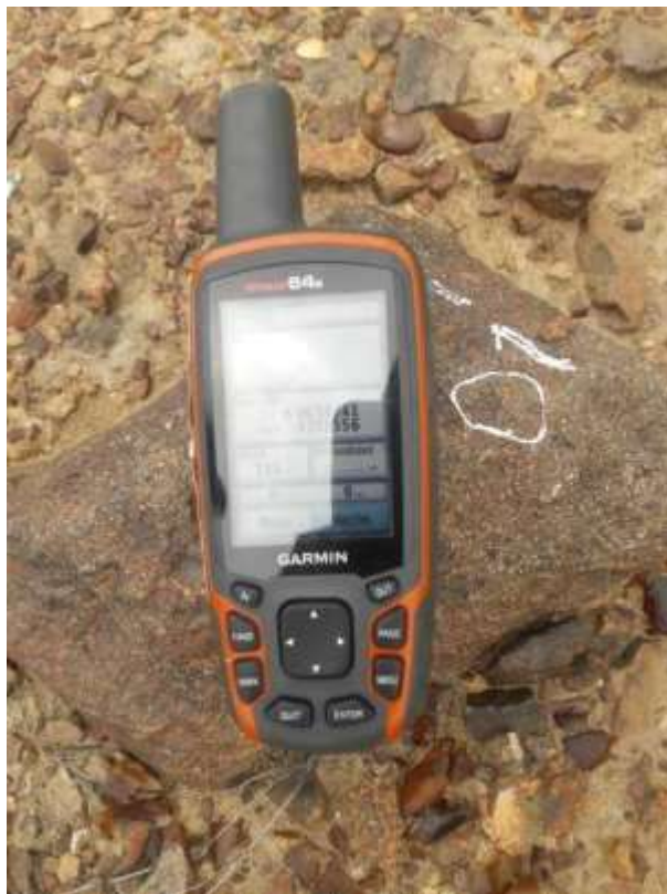
FOTOGRAFÍA N°4: Obteniendo coordenadas de BM
