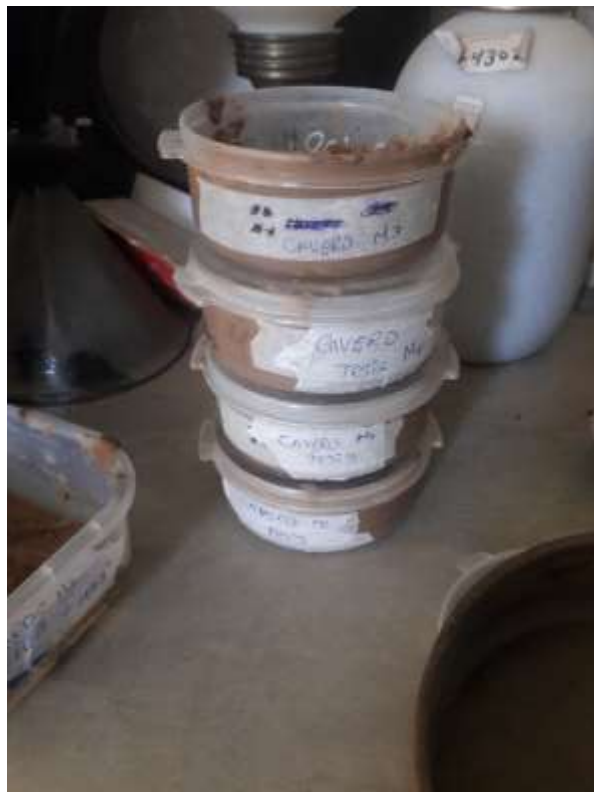
FOTOGRAFÍA N°2: Muestras humedecidas para ensayo
