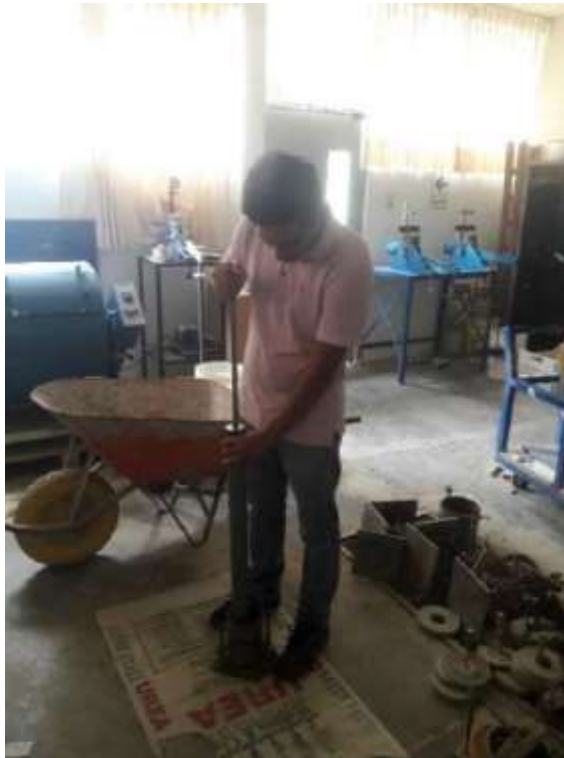
Fotografía N°10: Realizando ensayo de Proctor modificado
