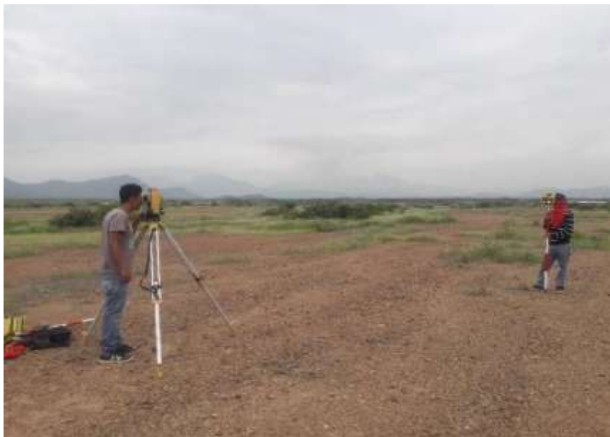
FOTOGRAFÍA N° 06: Topografía con Estación Total
