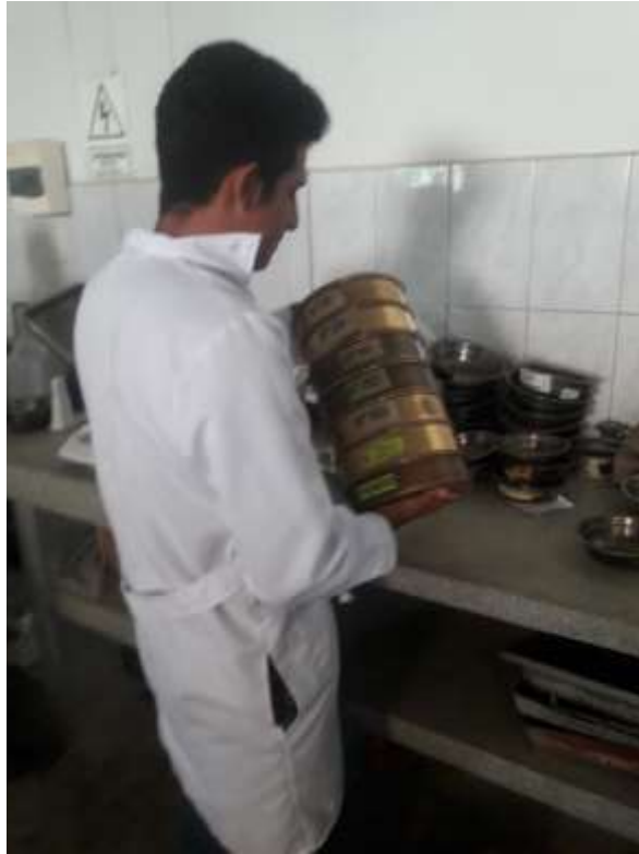
FOTOGRAFÍA N°1: Tamizado de muestras de suelo
