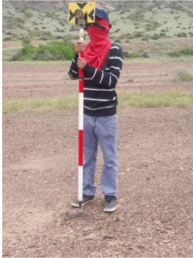
FOTOGRAFÍA N°5: Ayudante en utilización del prisma
