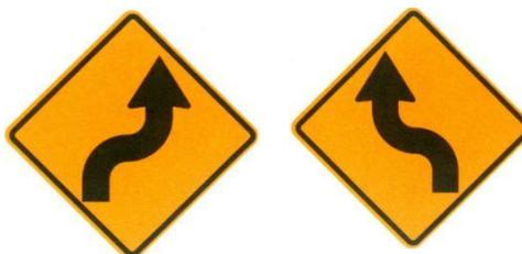
*Figura 10.10: Señal CURVA Y CONTRACURVA a la derecha (P-4A) y CURVA Y CONTRACURVA a la izquierda (P-4B)*
