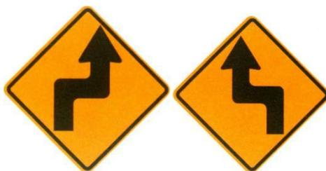
*Figura 10.9: Señal CURVA Y CONTRACURVA PRONUNCIADAS a la derecha (P-3A) y CURVA Y CONTRACURVA PRONUNCIADAS a la izquierda (P-3B)*
