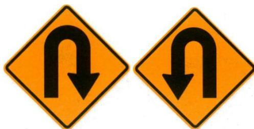
*Figura 10.12: Señal CURVA EN U a la derecha (P-5-2A) y CURVA EN U a la izquierda (P-5-2B)*
