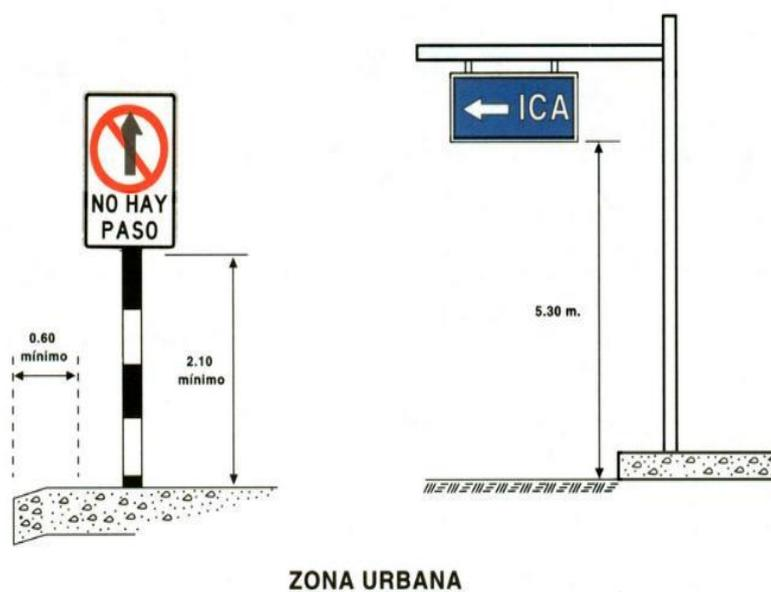
Figura 10.1: Ubicación y altura de las señales
