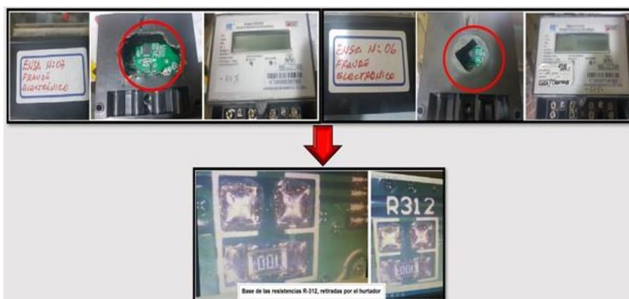
**Figura 42. Retiro de la resistencia R-312.**
