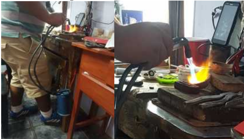
Imagen 1. Fundición de la Plata 950
