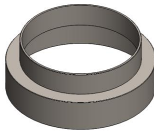
Fig. 28. Eje de perfil circular hueco
