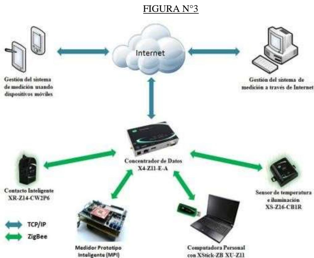
**Esquema del sistema de medición propuesto**
