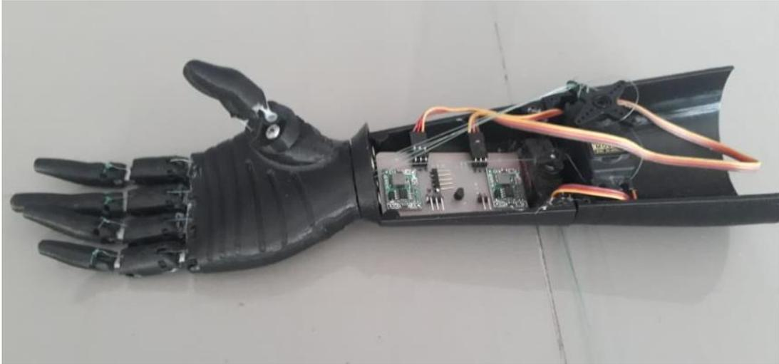
*Figura 114 Conexión de servomotores, Fuente: Propia*
