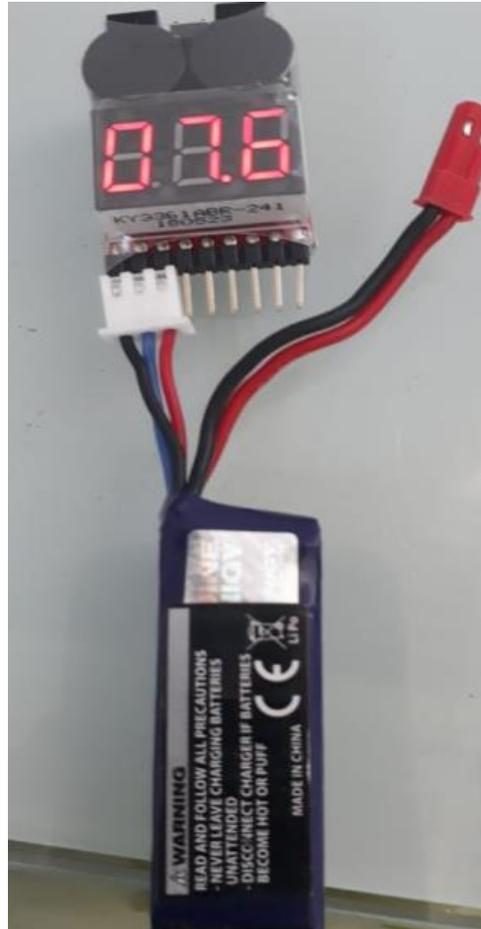
Figura 113 Batería lipo al 100% de su carga
