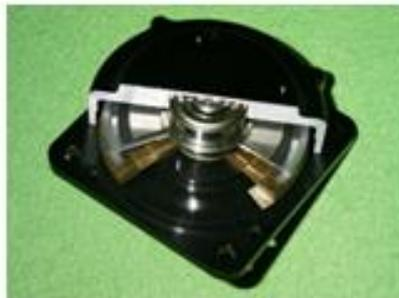
Figura 43 Motor ultrasónico
