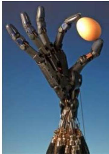
Figura 21 Prótesis neumática [52]
