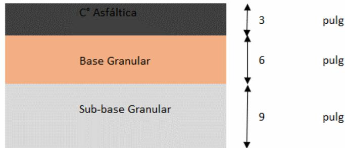
Diseño de espesores de las siguientes calles: Jr San Martin, Jr Tacna y Jr Micaela Bastidas I y II en las cuales sus CBR correspondientes fueron de 7,9% y 9,2% teniendo como un promedio de CBR a trabajar de 8,55% para realizar los siguientes calculos de diseño de pavimento:
