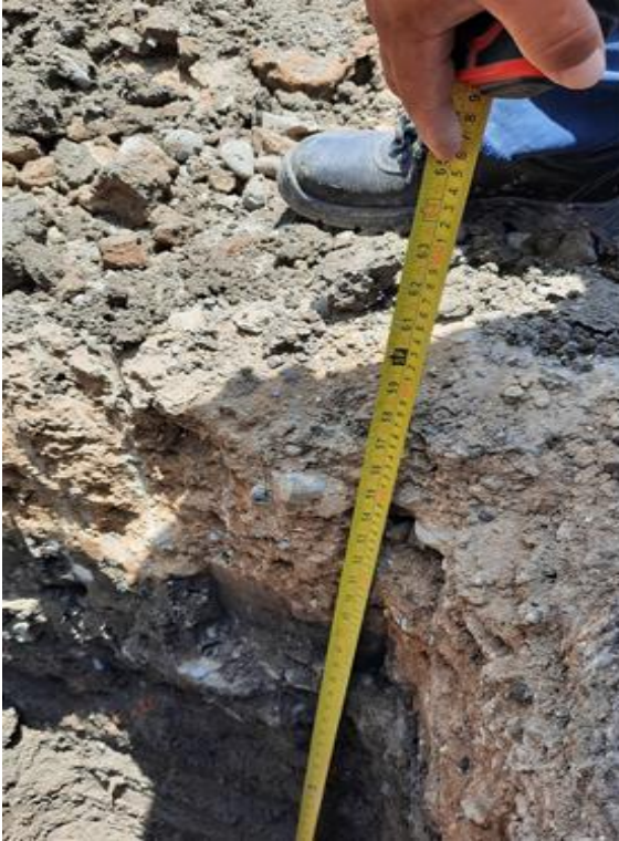
Imagen 10: Imágenes de la auscultación de pavimento en Alfonso Ugarte y Torres Paz
