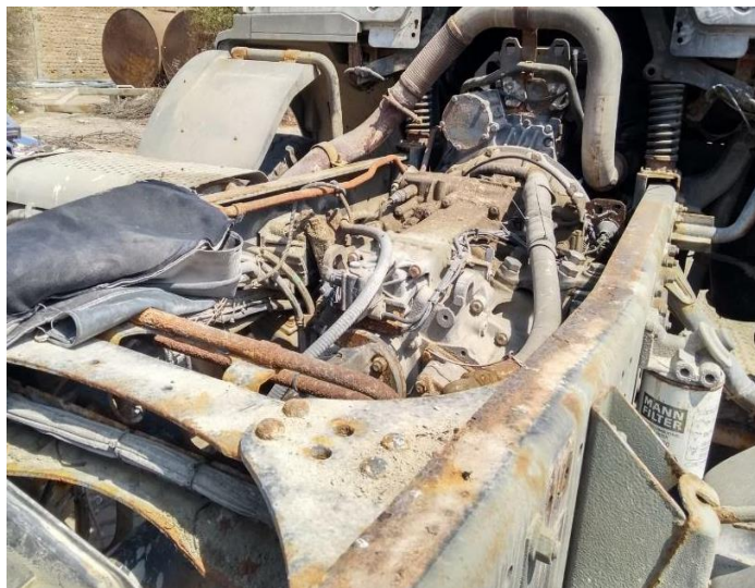
Figura 13 Fotos de unidad afectada por la corrosión
