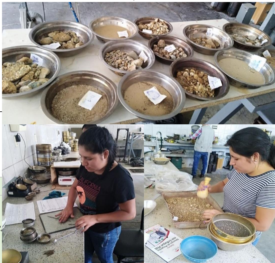
FIGURA 19: Muestras de suelos, Ensayo de Contenido de Humedad Y límites
