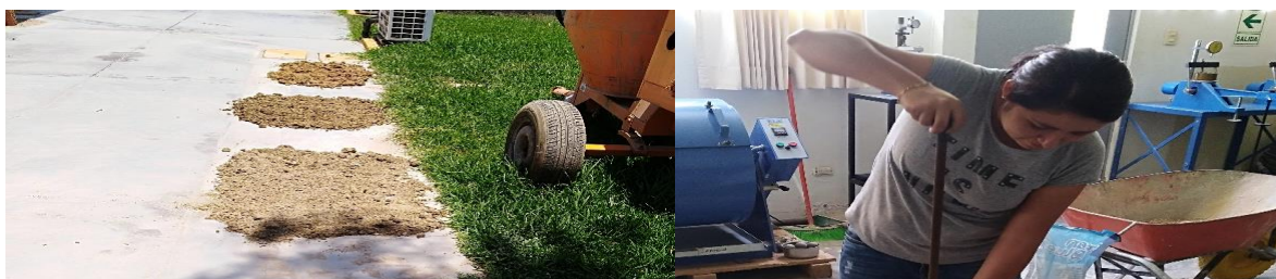
FIGURA 20: Ensayos Proctor y CBR
