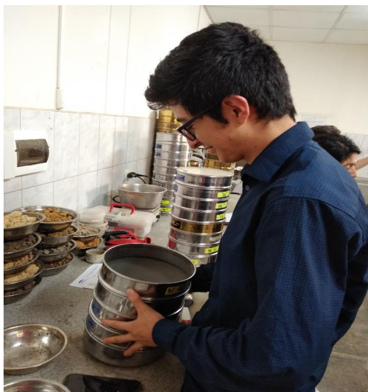
FOTOGRAFÍA N° 08 Tamizado de las muestras, para la obtención de la granulometría
