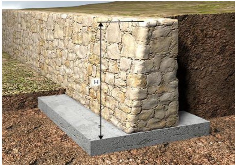
Fig. 13. MURO DE CONCRETO CICLÓPEO
