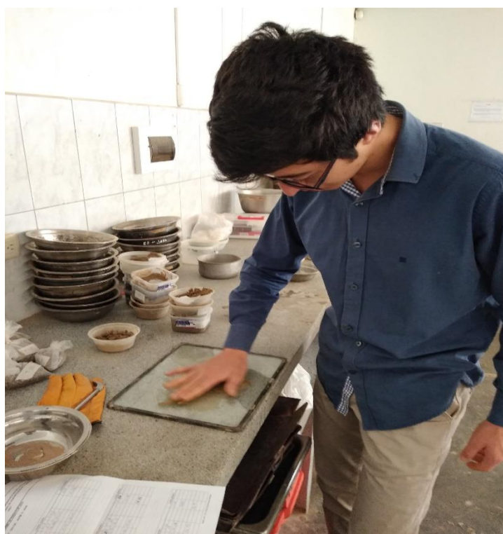
FOTOGRAFÍA N° 13 ensayo de Límite plástico
