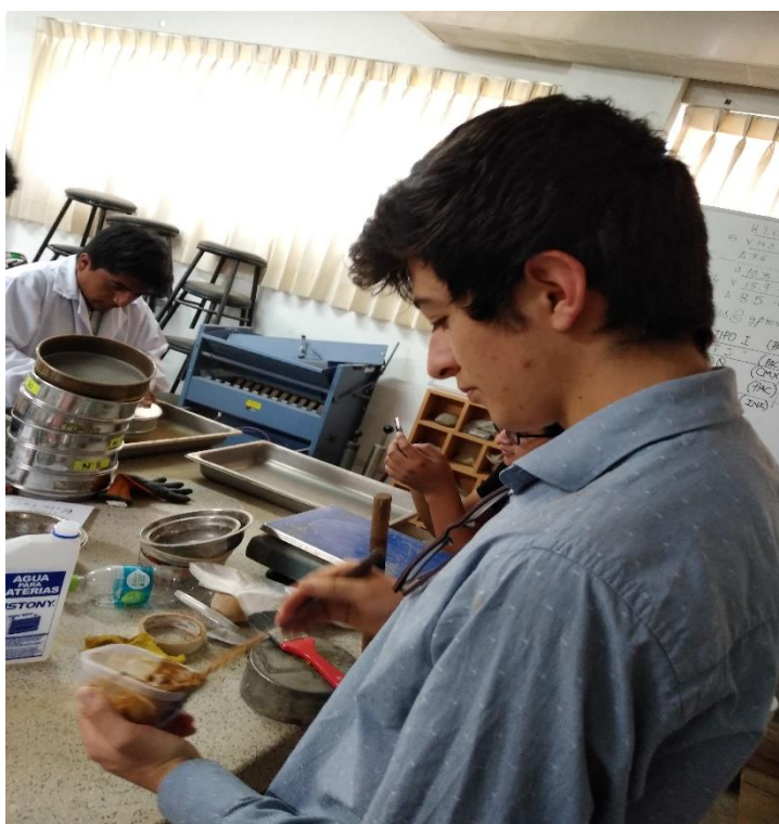
FOTOGRAFÍA N° 10 Preparación de muestra para los ensayos del Limite Líquido y Limite plástico
