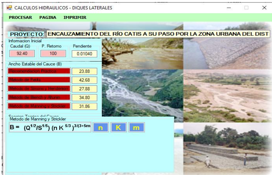
Fig. 48. CÁLCULO DEL ANCHO ESTABLE_ KM 0+000 - 0+065
