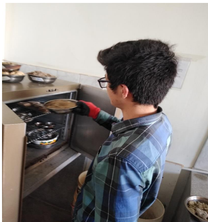
FOTOGRAFÍA N° 06 Colocación de muestras en el horno
