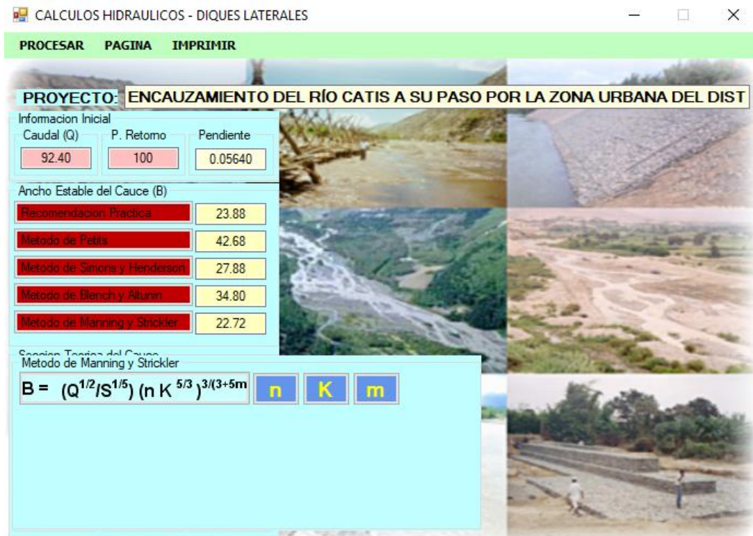
Fig. 57. CÁLCULO DEL ANCHO ESTABLE_ KM 0+625 - 0+660
