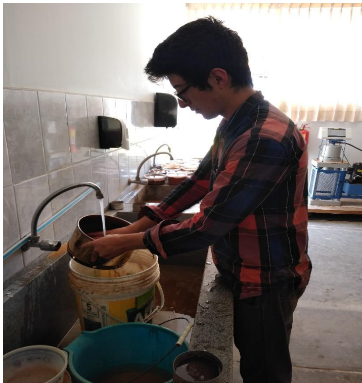
FOTOGRAFÍA N° 07 Lavado de las muestras para el ensayo de granulometría
