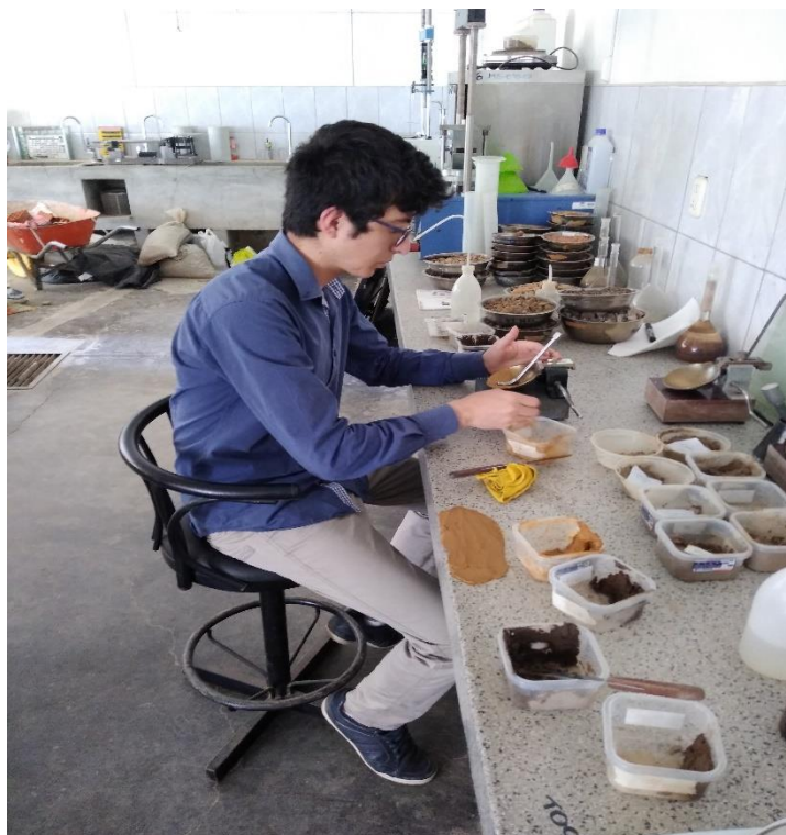
FOTOGRAFÍA N° 11 Utilización de la Cuchara de Casagrande para la obtención de Límite Líquido
