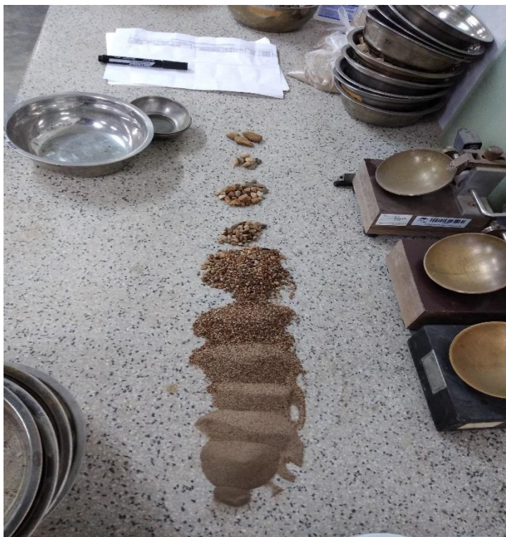
FOTOGRAFÍA N° 09 Muestra clasificada después del tamizado
