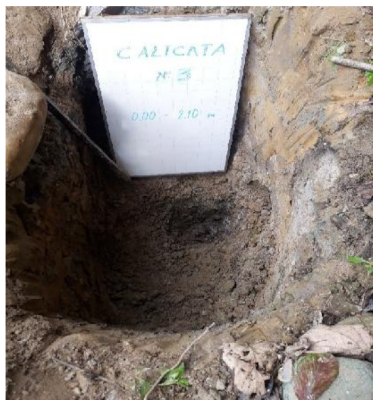
Fig. 19 VISTA PERFIL ESTRATIGRÁFICO EN CAMPO
