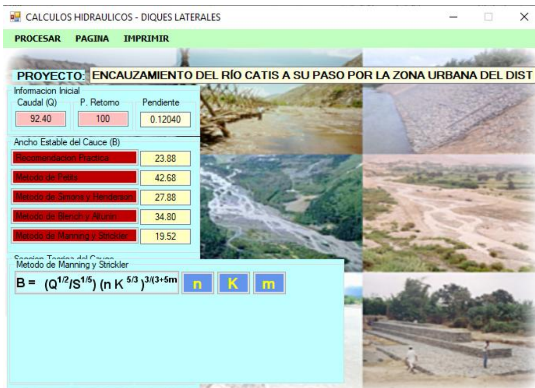
Fig. 58. CÁLCULO DEL ANCHO ESTABLE_ KM 0+660 - 0+681
