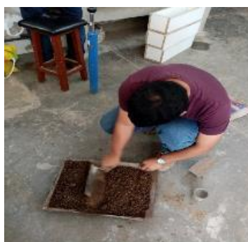
Imagen N° 34: Mezclado homogéneo agua más muestra de suelo
