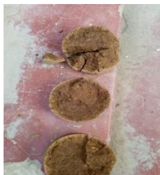
a) Especímenes con adición de almidón b) Especímenes con terreno natural Fuente propia, 2020
