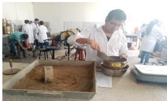
Imagen N° 33: Tamizado de la muestra con el tamiz N°4
