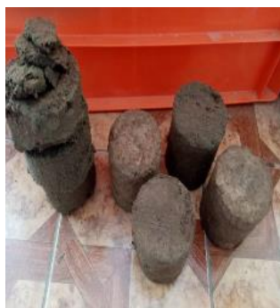
a) Especímenes con adición de almidón b) Especímenes con terreno natural Fuente propia, 2020
