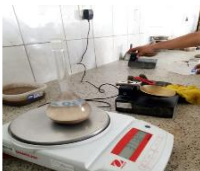
Imagen N° 26: Picnómetro más muestra de suelo con agua destilada
