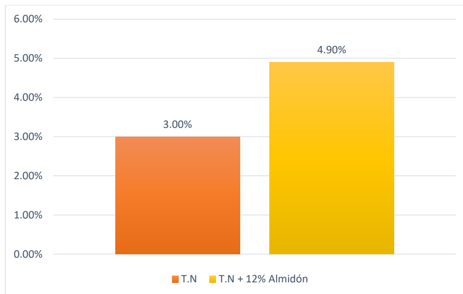
Gráfico N° 52: Comparación de CBR: T.N vs T.N + 12% Almidón de papa.
