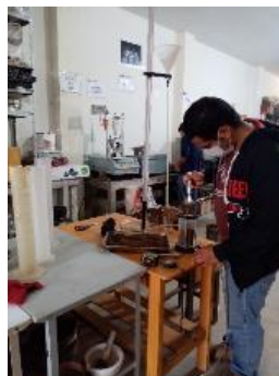
Imagen N° 44: Compactación de la muestra con el pinzón
