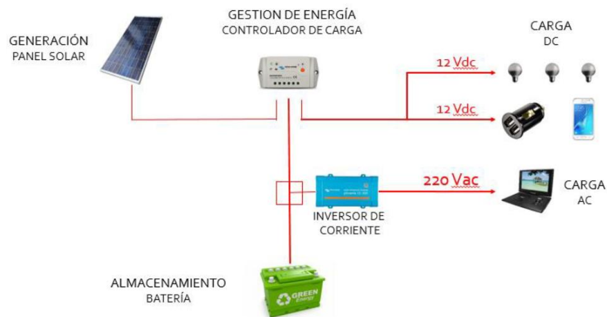
Figura 13: Componentes de un Sistema Off-grid. [10]
