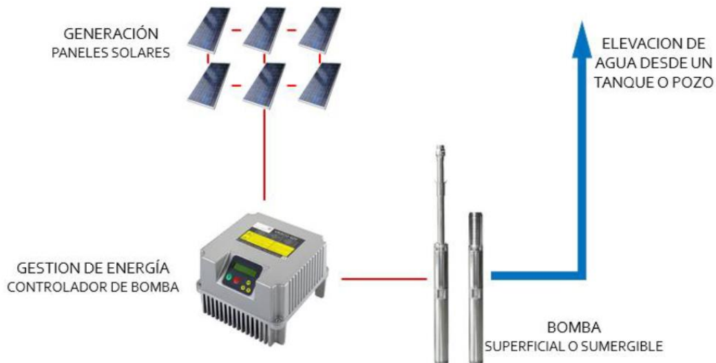
Figura 16: Componentes de un Sistema de Bombeo solar. [10]
