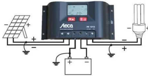
Figura 18: Controlador de carga o regulador de carga tipo PWM. [10]
