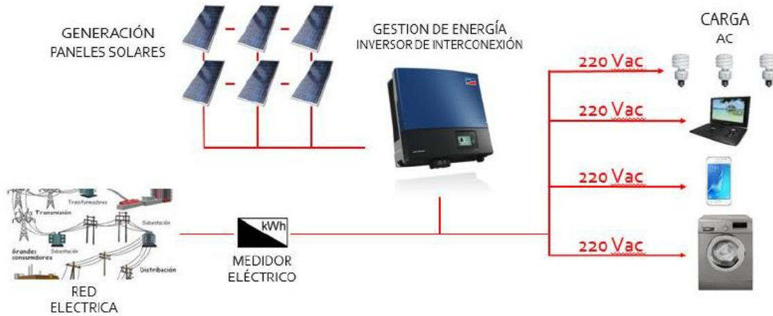
Figura 15: Componentes de un Sistema On-grid. [10]
