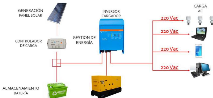
Figura 14: Componentes de un Sistema Híbrido. [10]
