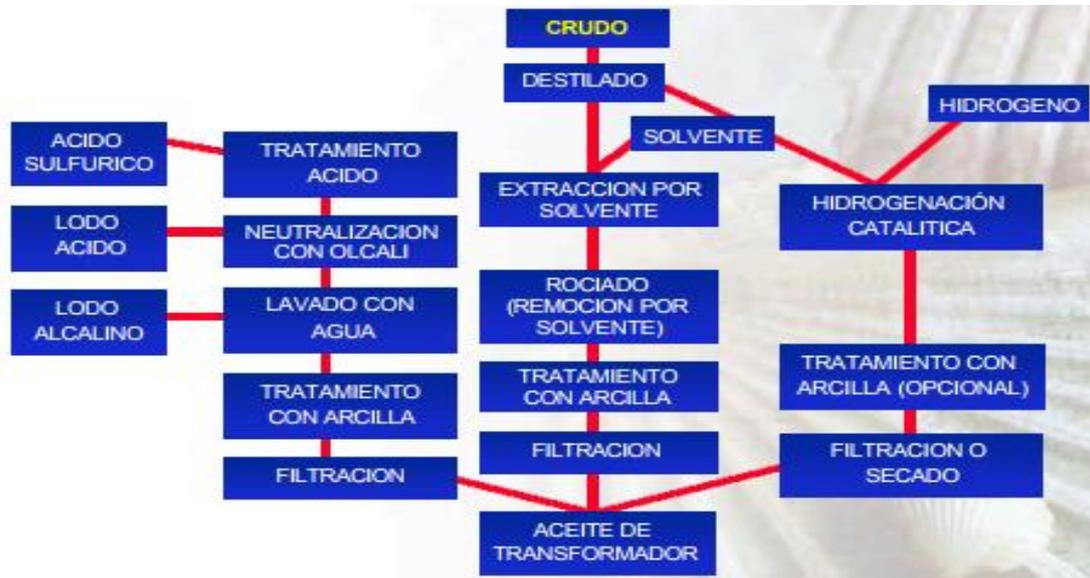
Figura 10: Proceso de fabricación de un aceite dieléctrico
