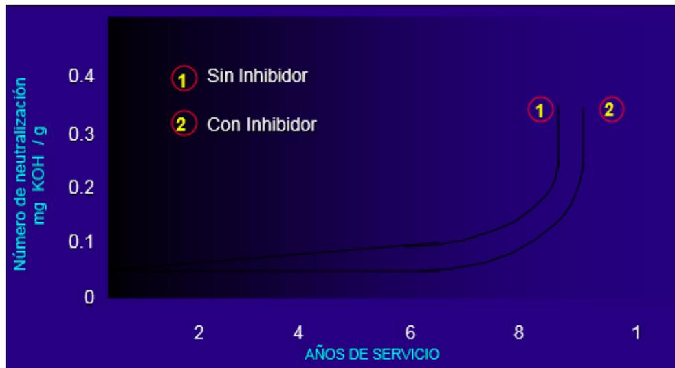
Figura 12: Curva de oxidación de un aceite dieléctrico
