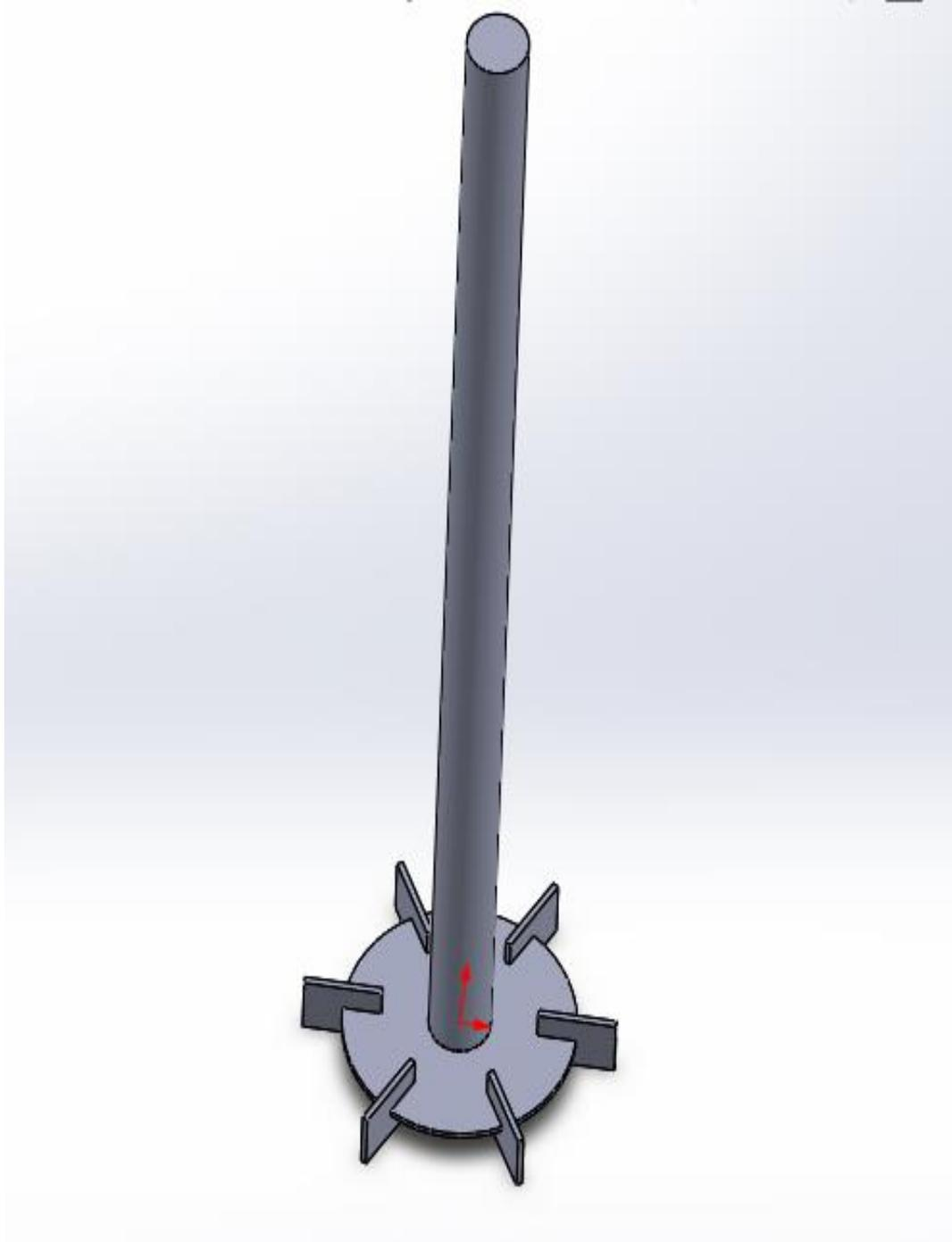
Figura 51: Turbina Rushton R-1 con eje
