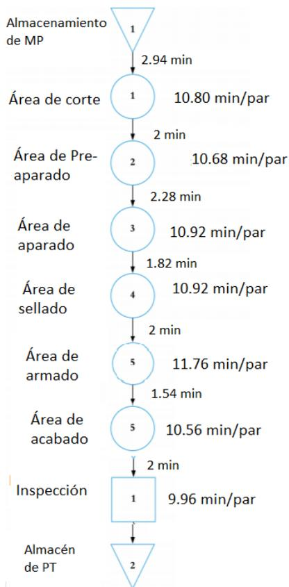
**Figura 1: Proceso de fabricación de calzado**
