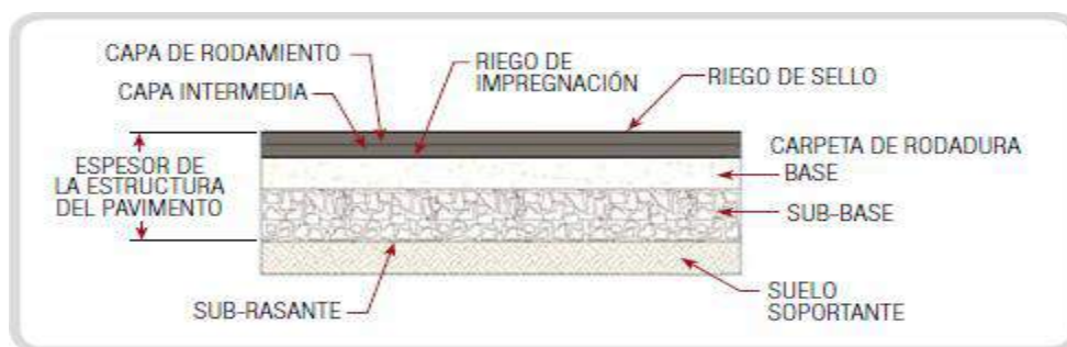
Figura N°01 Estructura de un Pavimento Flexible
