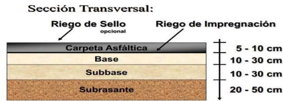
Figura N°02 Estructura De Un Pavimento Flexible
