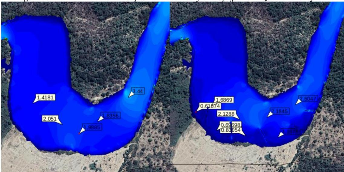
Figura N° 167. Velocidad Software HEC-RAS en zona Abrojal.
