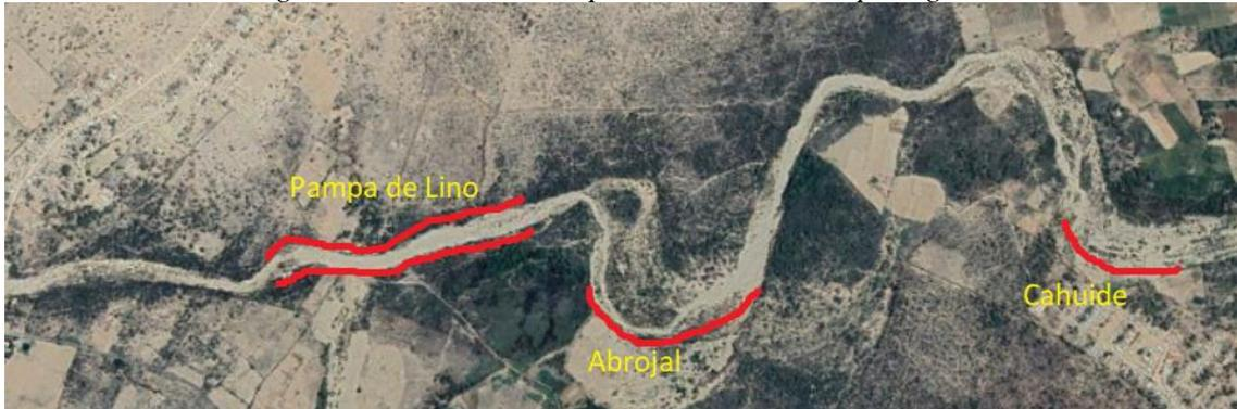
Figura N° 141. Paso del agua con la colocación de diques en la zona de Pampa de Lino y la colocación de espigones en la zona de abrojal.
