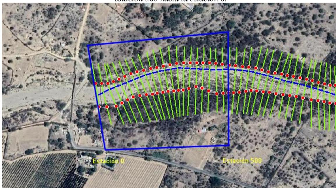
**Erosión en cauce descolmatado:** a pesar de realizar la descolmatación del cauce los resultados de erosión y agradación son muy similares al análisis anterior. Ver imagen de perfil longitudinal a más detalle en anexo 9.4.
