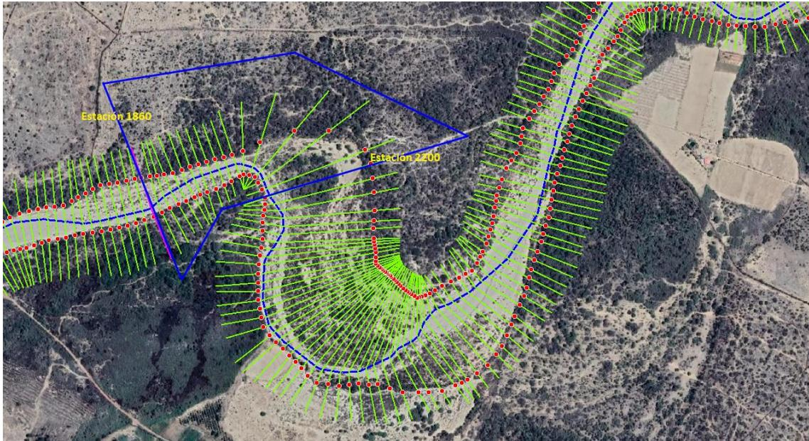
Estación 4000 a la estación 4600. En esta zona la máxima erosión se genera por una disminución del ancho del cauce y además por la sinuosidad presente.
