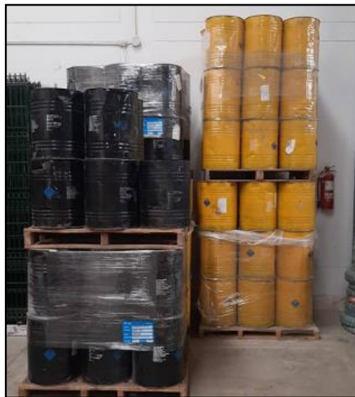
Ilustración 12 Material altamente inflamable sin aislamiento correcto
