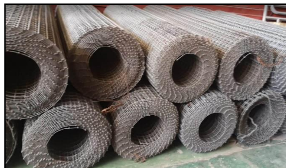
Ilustración 21 Oxidación de mallas por excesivo almacenamiento
