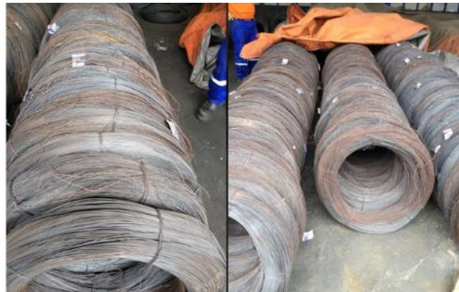
Ilustración 17 Oxidación de alambres por mal almacenamiento
