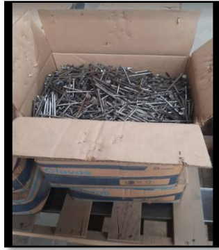
Ilustración 16 Oxidación de clavos por excesivo almacenamiento
