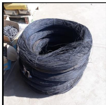
Ilustración 15 Deterioro y desperfecto de material por mala manipulación
