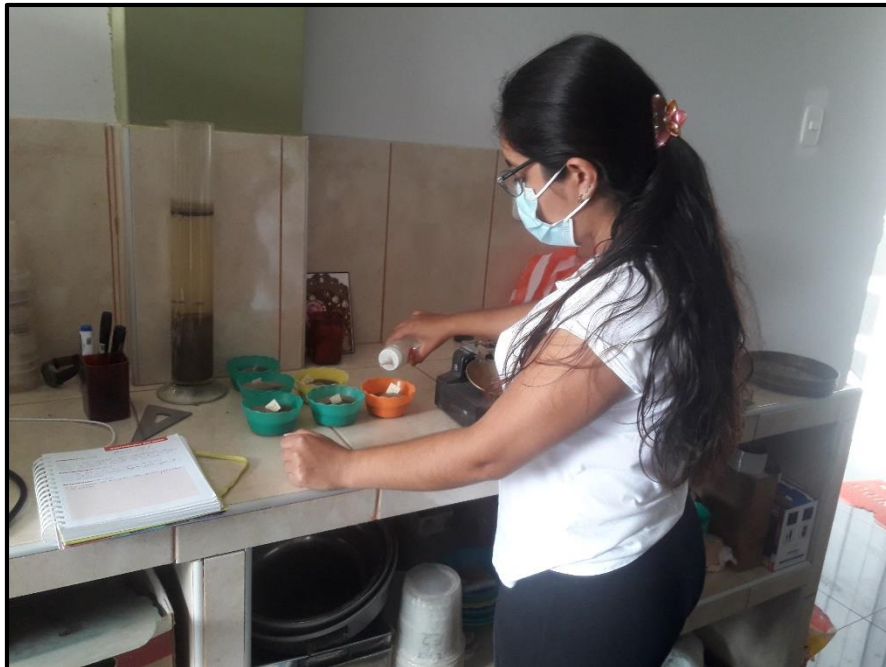
Fotografía 3.28 Separando cada muestra de cada calicata
