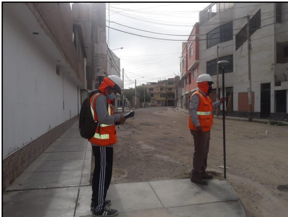
Fotografía 3.31 Toma de datos de campo, veredas existentes con equipo GPS DIFERENCIAL TRIMBLE
