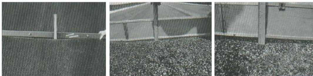
Figura 15. De izquierda a derecha, falla por ahuellamiento de baja, media y alta severidad
