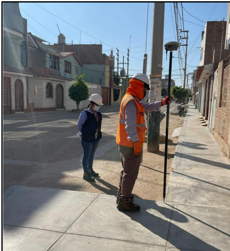
Fotografía 3.30 Toma de datos de campo, veredas existentes con equipo GPS DIFERENCIAL TRIMBLE
