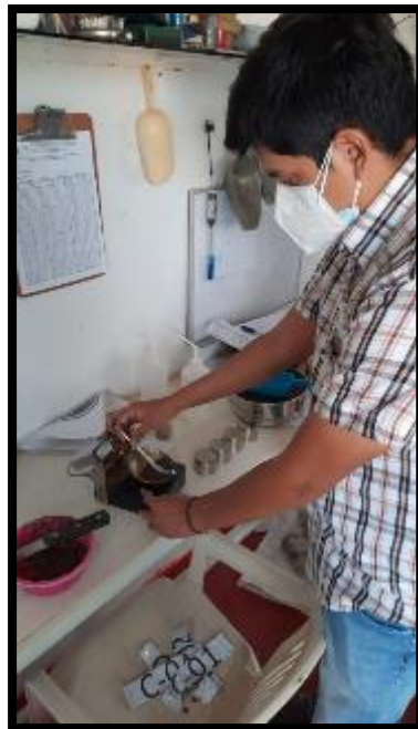
Fotografía 28- Desarrollando el ensayo de límites
