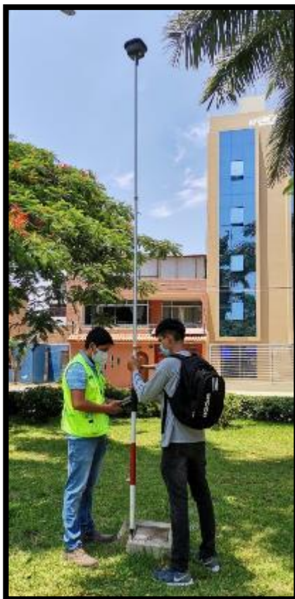
Fotografía 09- Toma de punto del BM 03 con el GPS receptor dinámico
