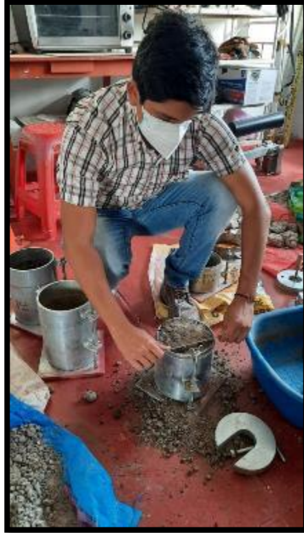
Fotografía 27- Enrazando la muestra del CBR
