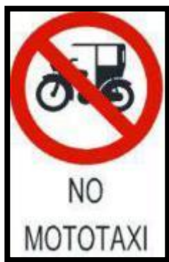
Figura 56- Señal de Prohibido Circulación de Vehículos Motorizados de Tres Ruedas Mototaxis (R-45)
