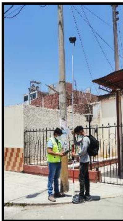
Fotografía 08- Toma de punto del BM 02 con el GPS receptor dinámico
