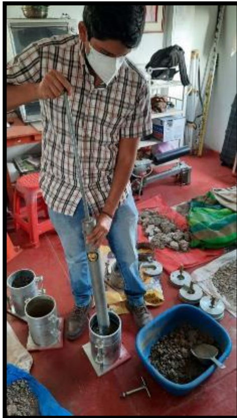
Fotografía 26- Desarrollando el ensayo de CBR
