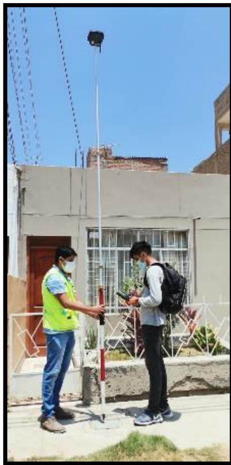
Fotografía 05- Toma de punto de caja de agua potable con el GPS receptor dinámico
