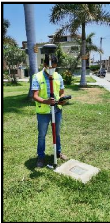
Fotografía 07- Toma de punto del BM 01 con el GPS receptor dinámico
