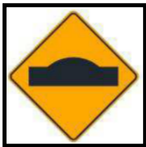
Figura 64- Señal proximidad reductor de velocidad tipo resalto (P-33A)
