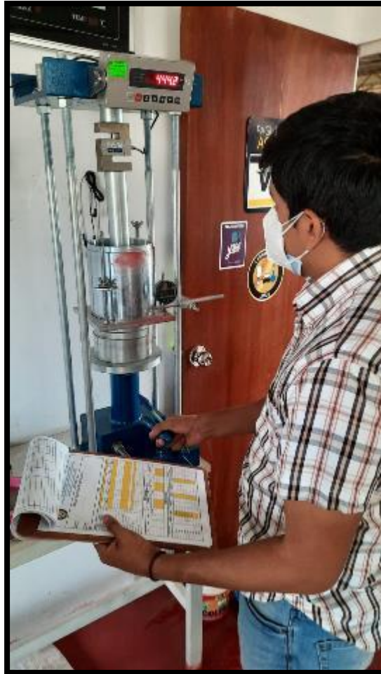
Fotografía 29- Desarrollando la prueba de CBR (Prensa Hidráulica)
