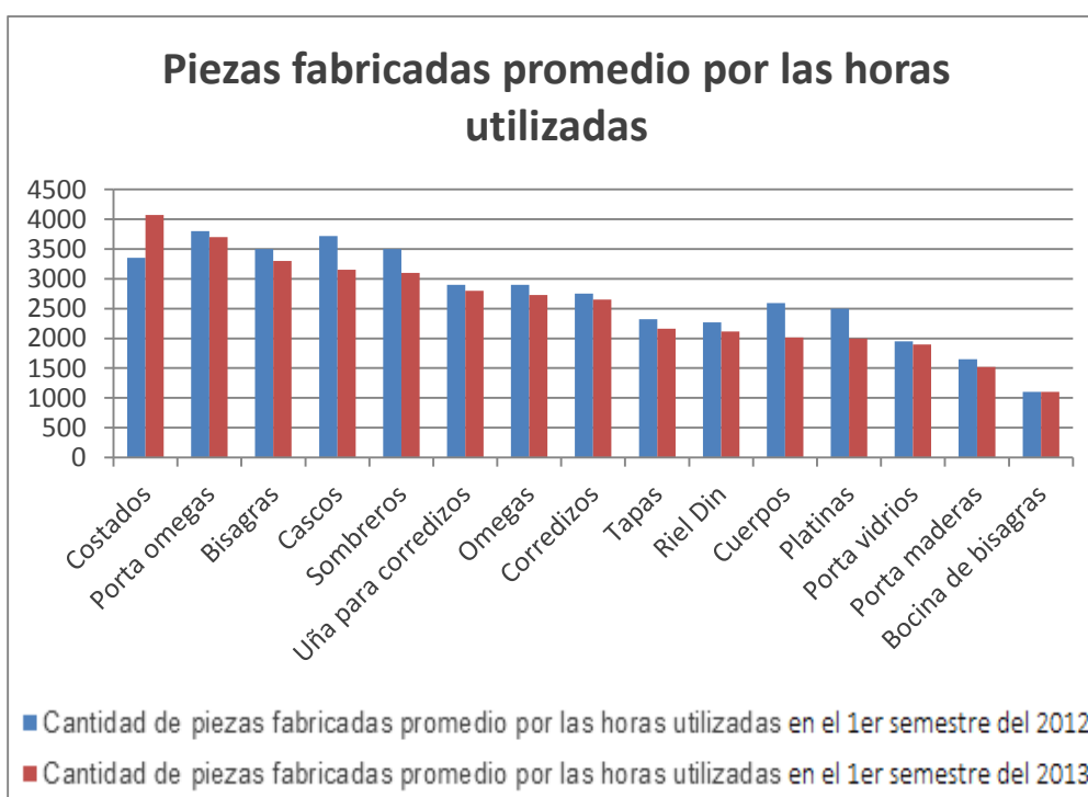
Gráfico 4. Cantidad de piezas fabricadas promedio por las horas utilizadas en cada etapa del proceso productivo de cajas porta-medidores de energía monofásicas en el 1er semestre del año 2012 y 2013
