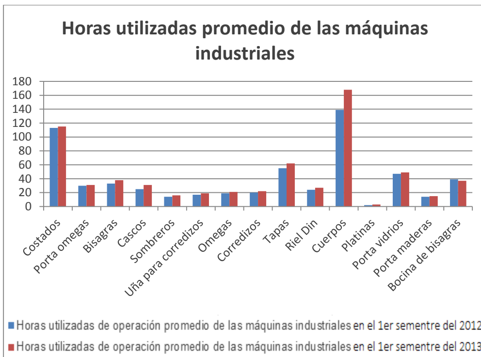
Gráfico 3. Horas utilizadas de operación promedio de las máquinas industriales en cada etapa del proceso productivo de cajas porta-medidores de energía monofásicas en el 1er semestre del año 2012 y 2013
