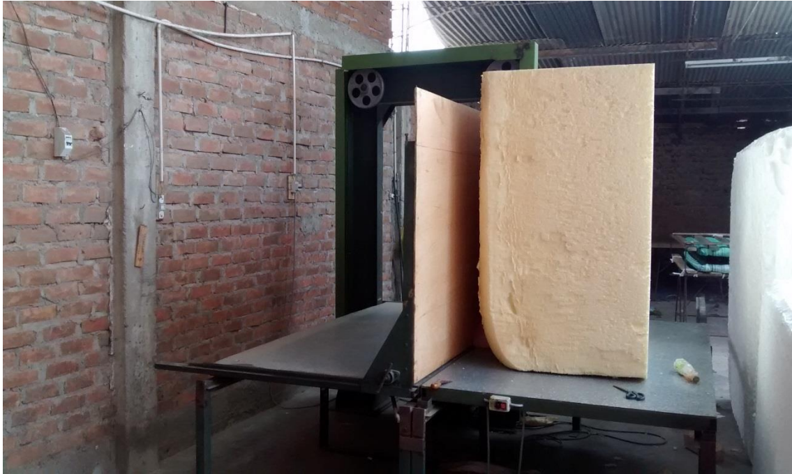
Figura N° 12: Máquina cortadora de espuma
